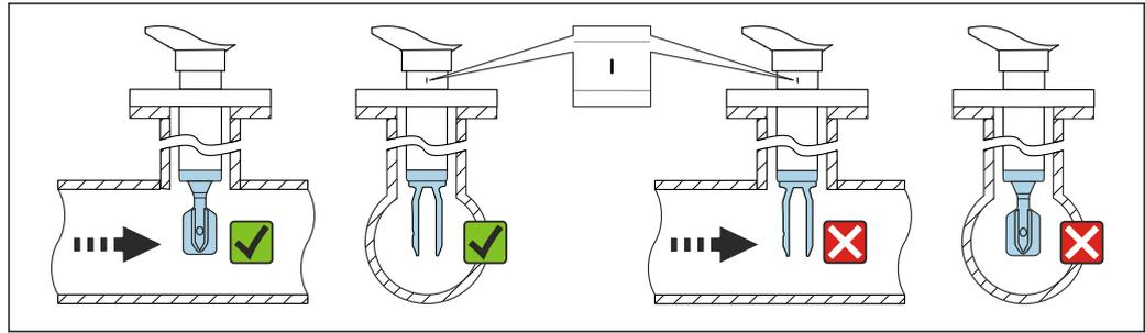
13 Einbau in Rohrleitungen (Gabelstellung und Markierung berücksichtigen)
