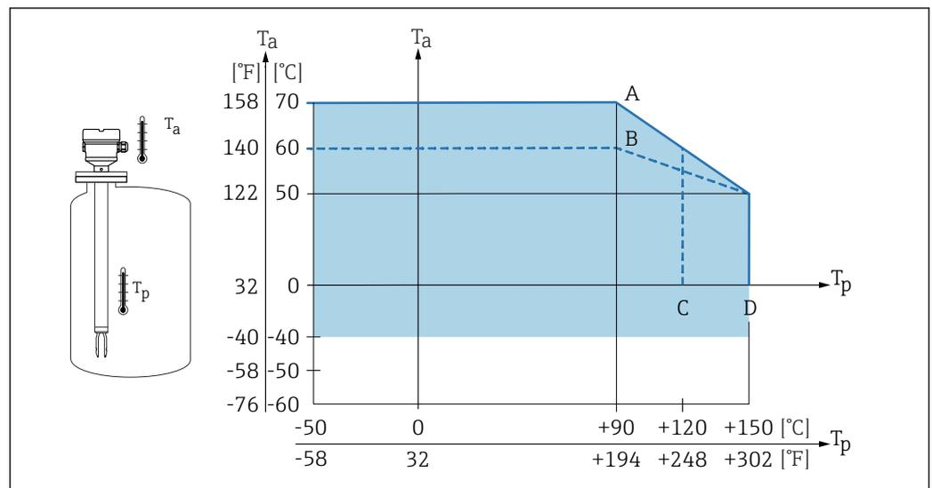
49 Zulässige Umgebungstemperatur  $T_a$  am Gehäuse in Abhängigkeit von der Prozesstemperatur  $T_p$  im Behälter:
