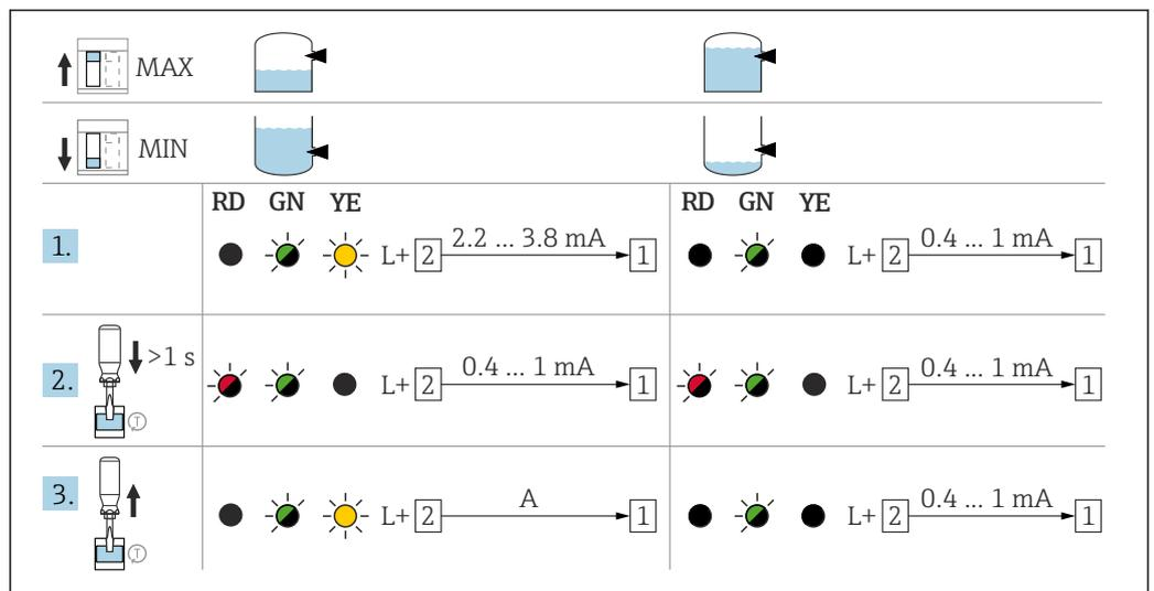
41 Schaltverhalten und Signalisierung NAMUR-Elektronik
