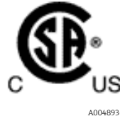
Figura 5. Etiqueta que mostra que o equipamento está aprovado para uso em áreas classificadas nos Estados Unidos e Canadá
