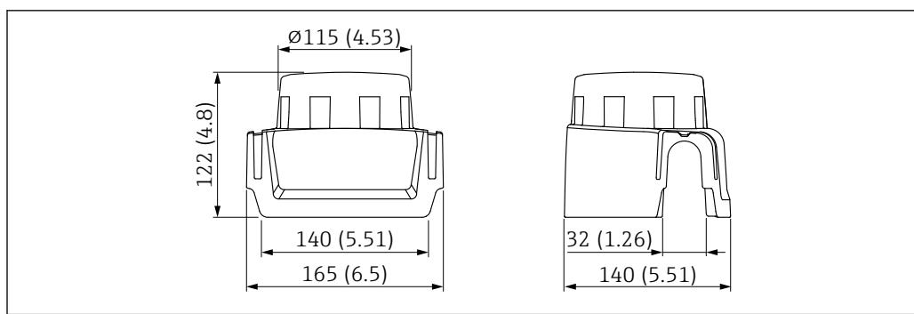
■ 45 Защитный козырек для однокамерного корпуса, алюминий или 316L. Единица измерения мм (дюйм)
