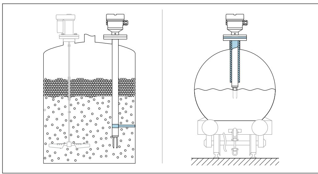
■ 9 Примеры обеспечения опоры при динамической нагрузке
