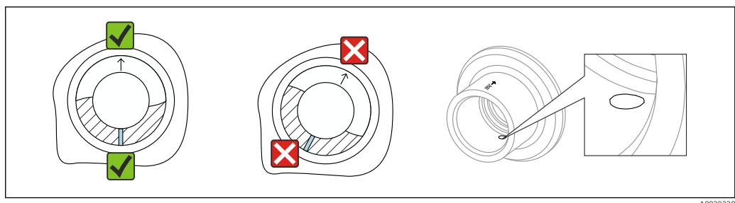
■ 10 Сварной переходник с отверстием для утечек
