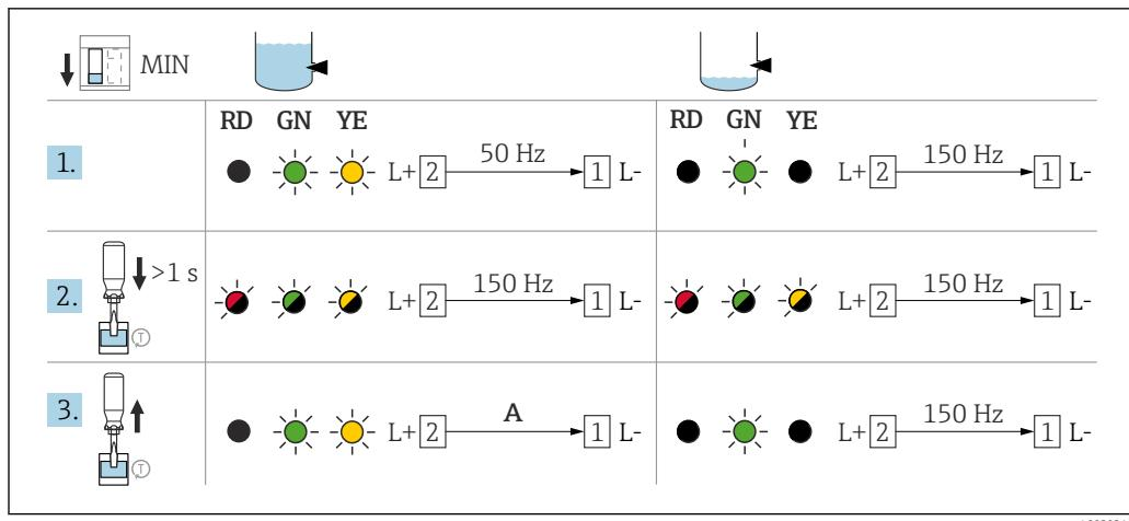
■ 39 Поведение при переключении и сигнализация электронной вставки FEL67 в режиме MIN
