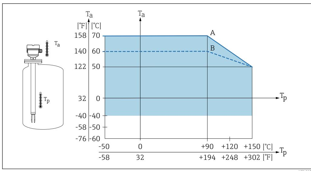
■ 51 Нижне приведена зависимость допустимой температуры окружающей среды  $T_a$  в зоне корпуса от рабочей температуры  $T_p$  в резервуаре:
