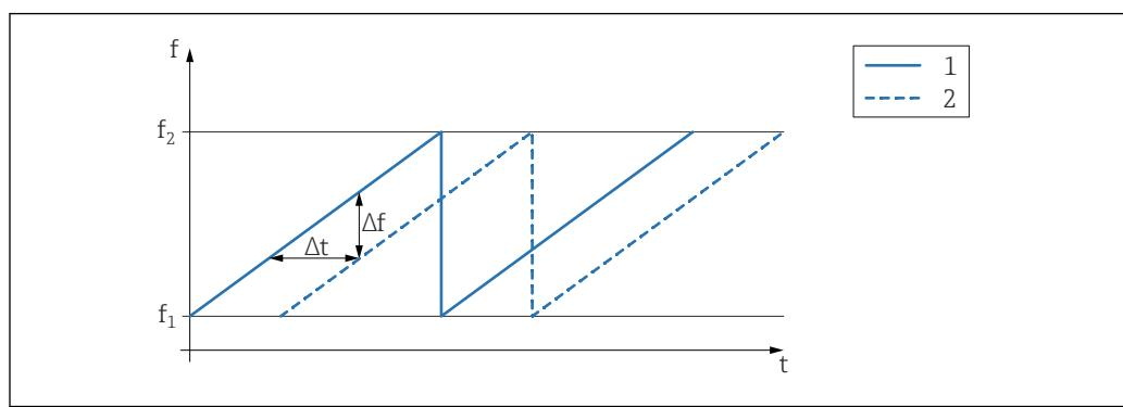
2 Принцип FMCW: результат частотной модуляции
