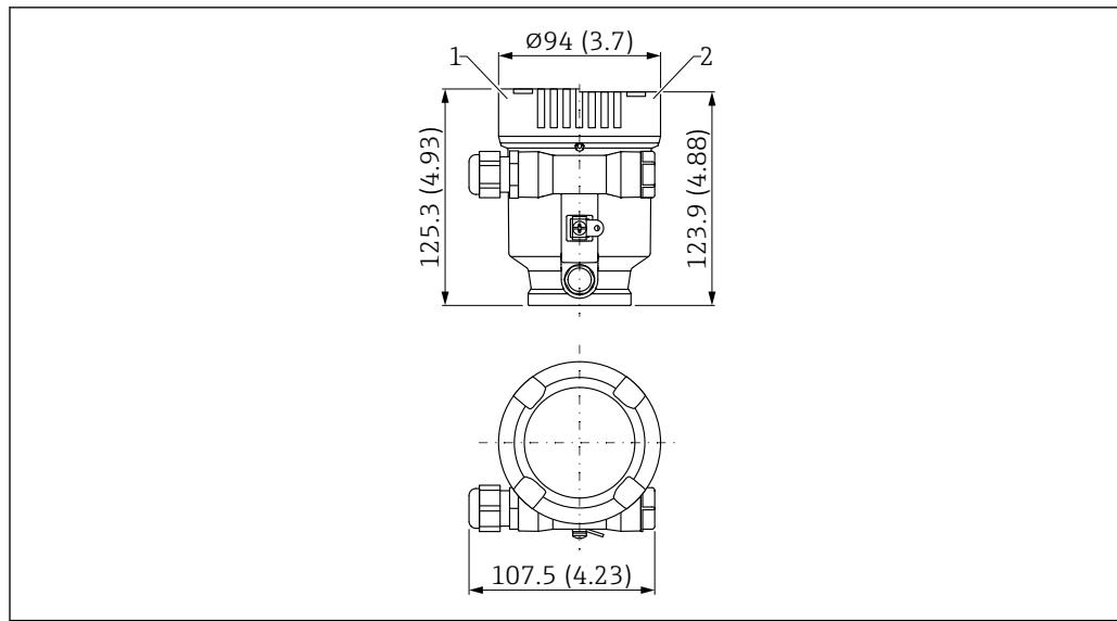
52 Размеры пластмассового корпуса с одним отсеком (PBT). Единица измерения мм (дюйм)
