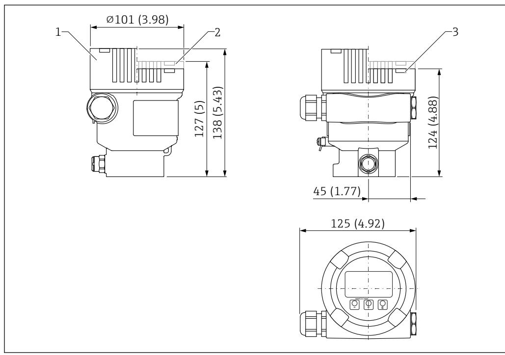
53 Размеры алюминиевого корпуса с одним отсеком. Единица измерения мм (дюйм)
