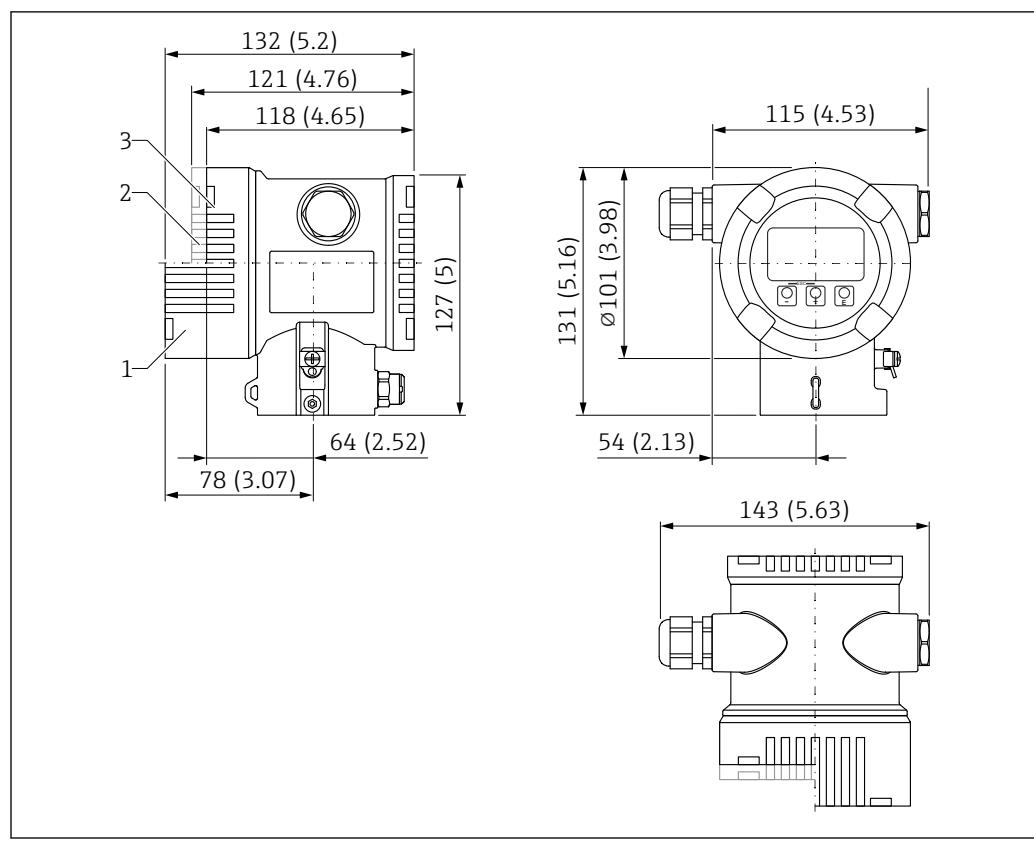
■ 55 Размеры корпуса с двумя отсеками. Единица измерения мм (дюйм)
