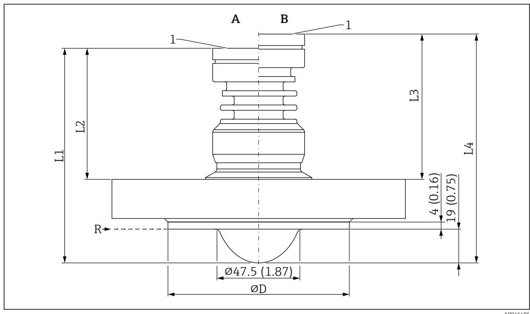
■ 59 Размеры плакированной материалом PTFE антенны, монтируемой заподлицо, 50 мм (2 дюйм), с фланцем. Единица измерения мм (дюйм)
