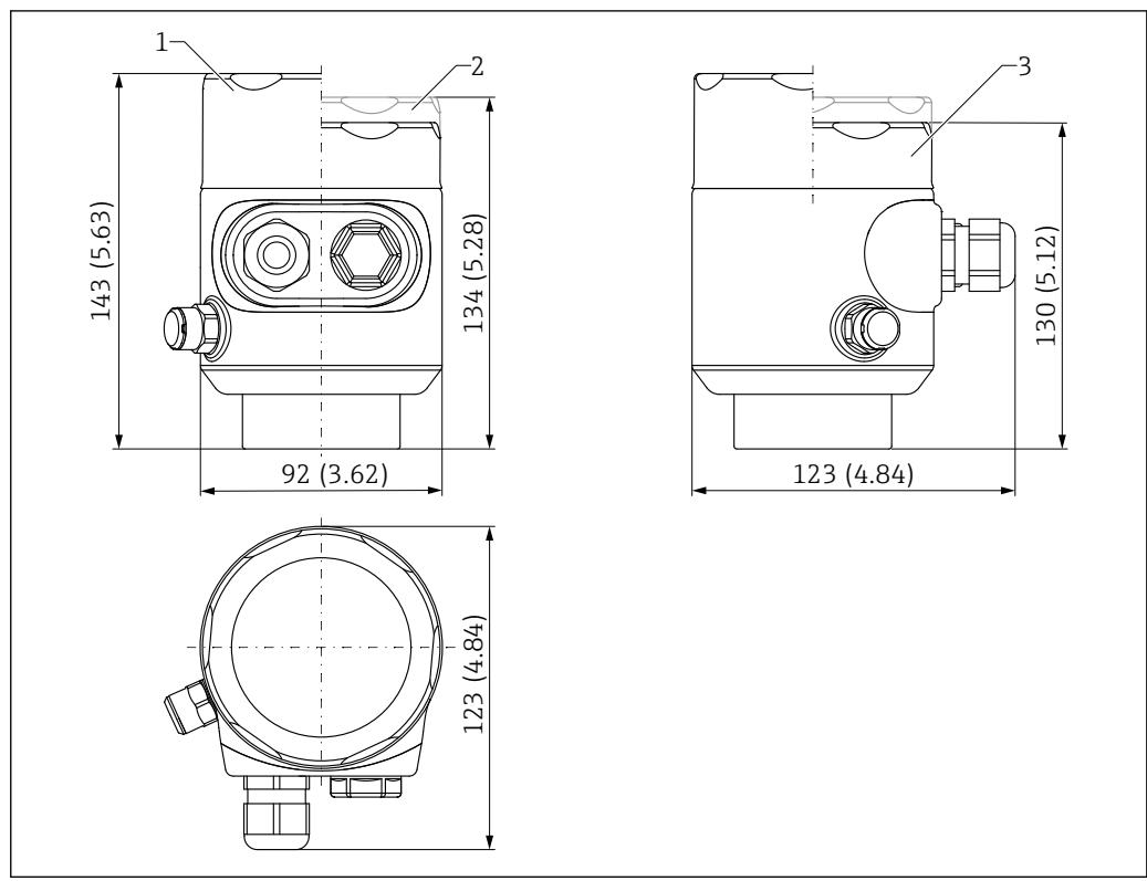
54 Размеры гигиенического корпуса с одним отсеком 316L. Единица измерения мм (дюйм)
