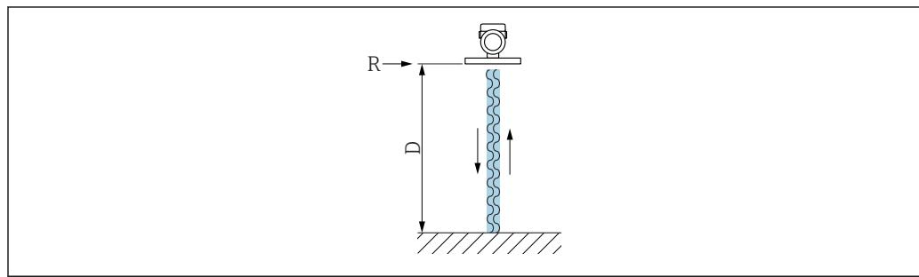
1 Принцип FMCW: излучение и отражение непрерывной волны
