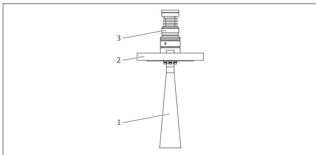
61 *Материал; рупорная антенна DN65. Единица измерения мм (дюйм)*
