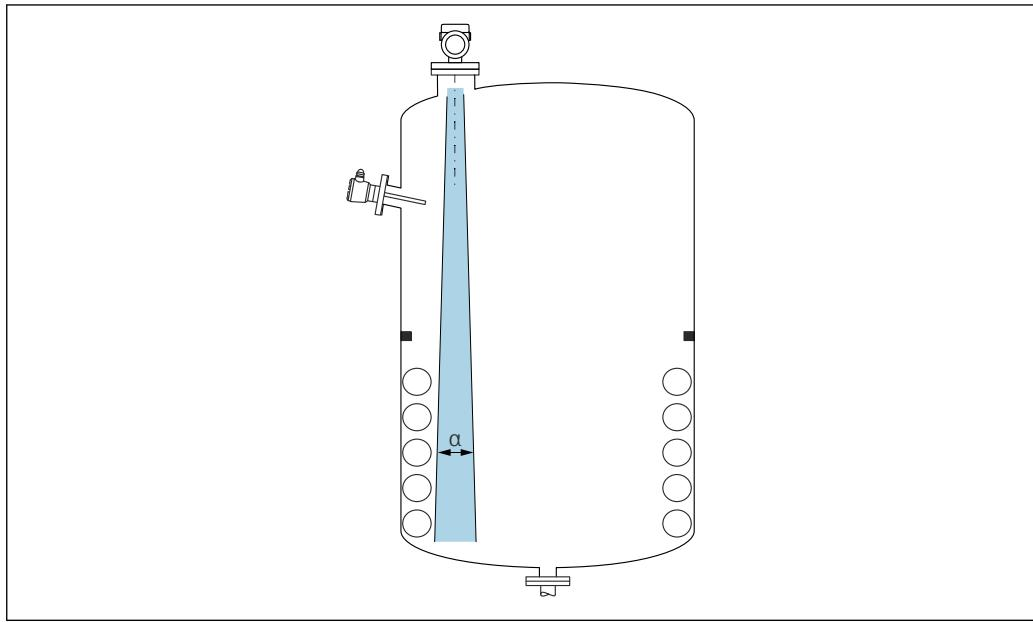
Избегайте установки внутренних устройств (датчиков предельного уровня, датчиков температуры, стержней, вакуумных колец, теплообменников, перегородок и т. п.) в зоне распространения сигнального луча. Учитывайте угол расхождения луча  $\alpha$ .
