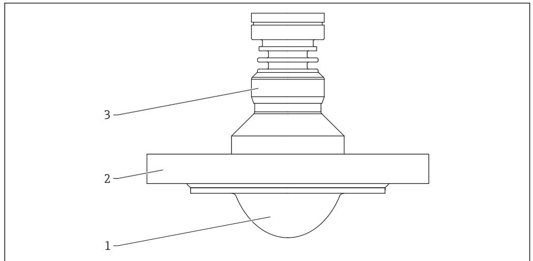
64 Material: antena, revestida com montagem flush, PTFE, 80 mm (3 in), com flange
