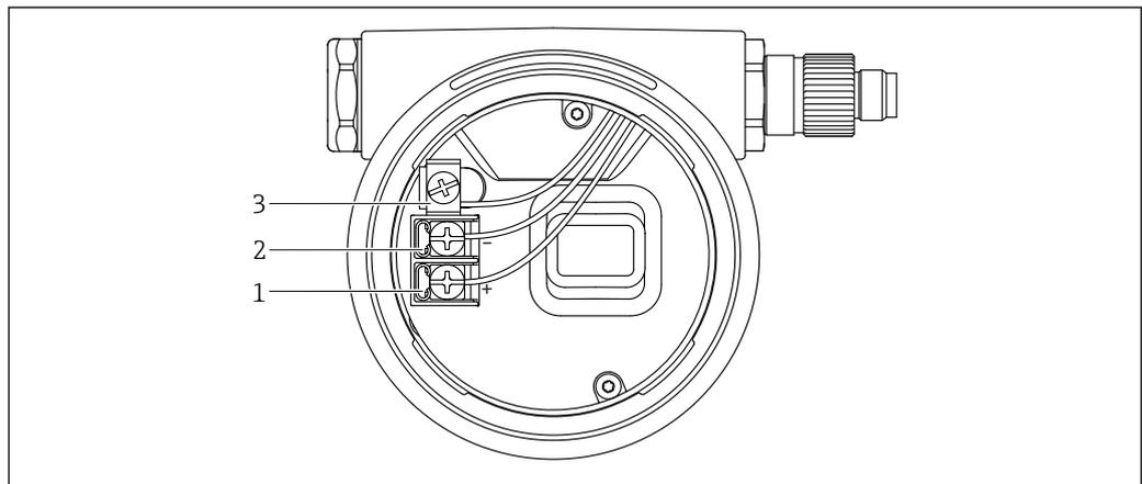
4 Os terminais de conexão e os terminais de terra no compartimento de conexão
