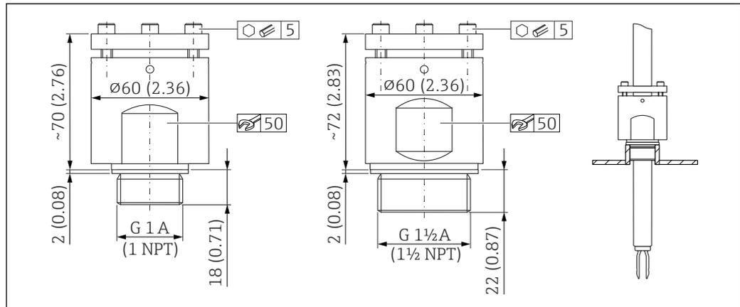
図 65 高圧用スライディングスリーブ。測定単位 mm (in)
