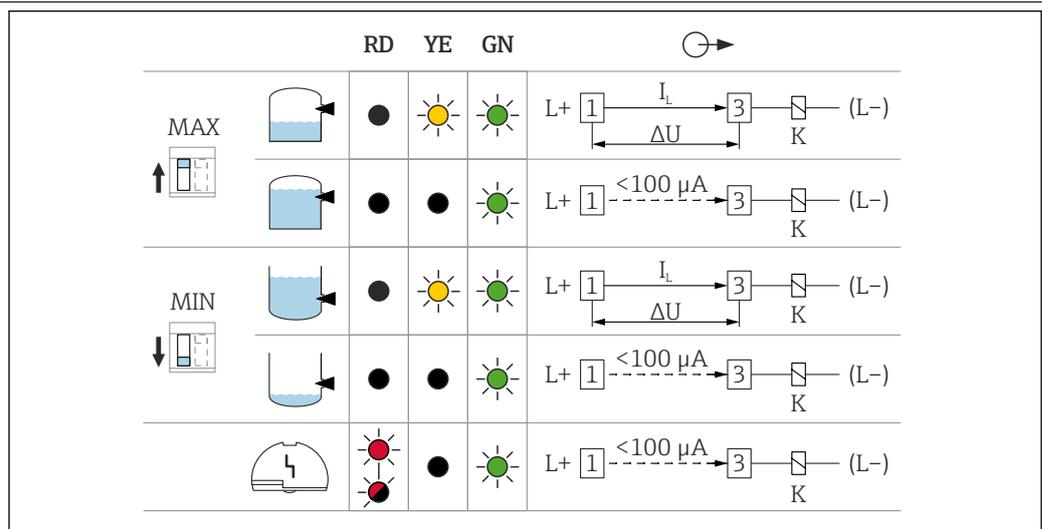
図 6 スwitch出力および信号伝達の動作、エレクトロニックインサート FEL62
