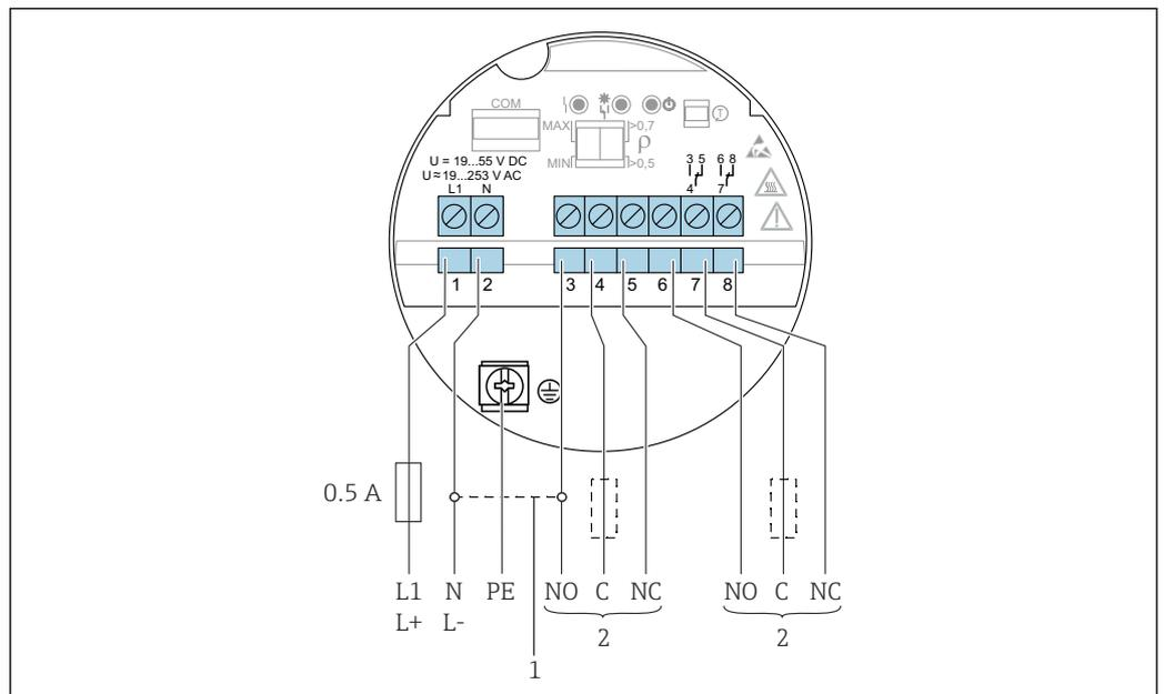
図 7 AC/DC 両用リレー出力接続、エレクトロニクスインサート FEL64
