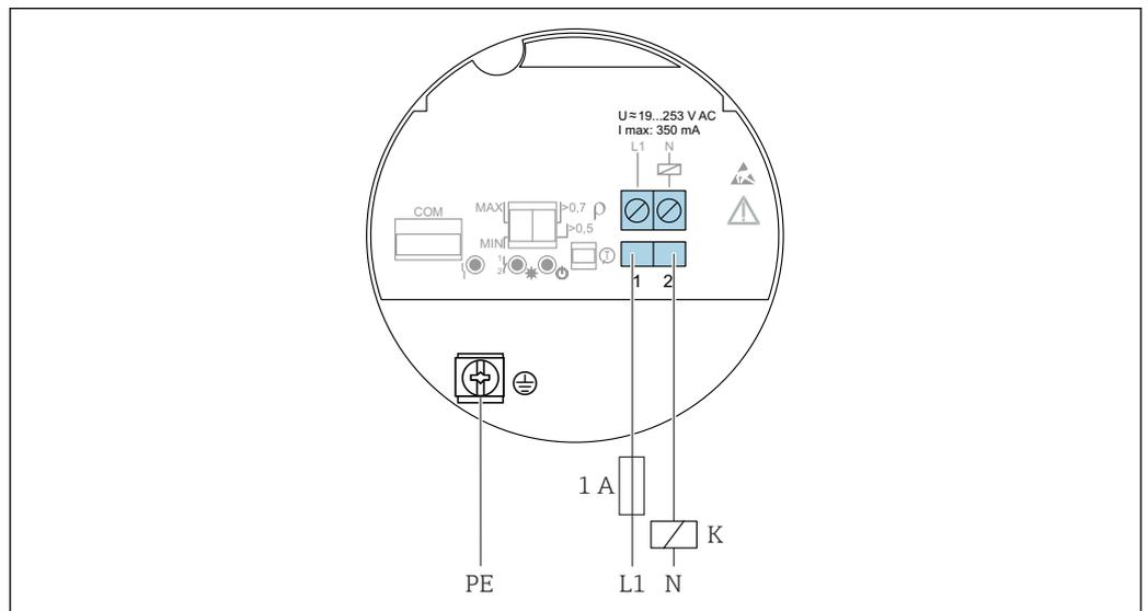
図 2 2 線式 AC、エレクトロニックインサート FEL61
