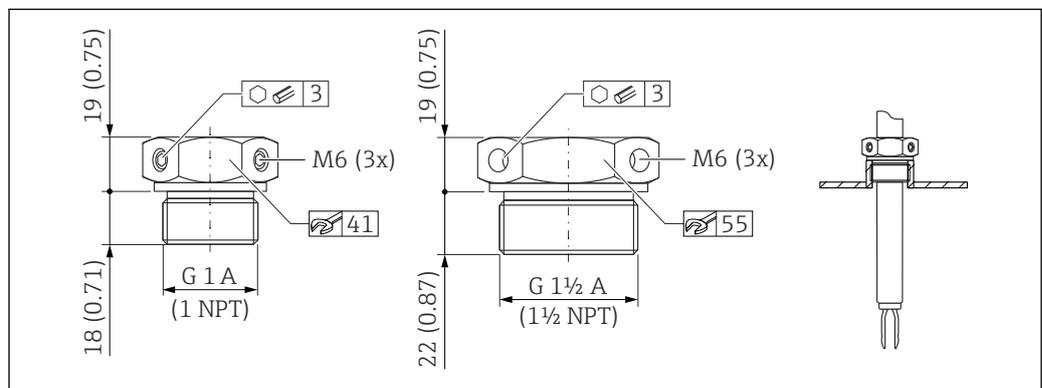
図 54 スライディングスリーブ (大気圧用 :  $p_e = 0\text{ MPa}$  (0 psi))。測定単位 mm (in)
