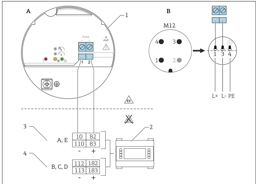
図3 接続図：エレクトロニックインサート FEL60D とデンシティコンピュータ FML621 の接続
