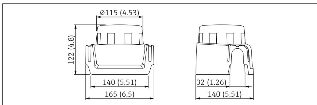
図 53 シングルコンパートメントハウジング用の保護カバー、アルミニウムまたは SUS 316L 相当。測定単位 mm (in)
