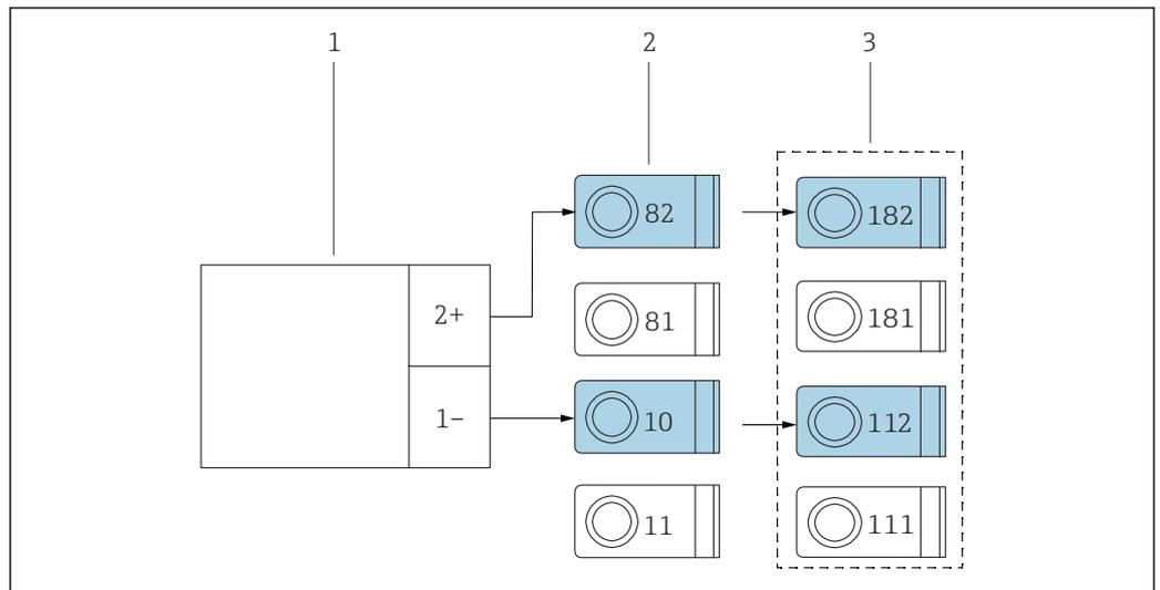
図 12 パッシブ電流出力付き圧力センサ
