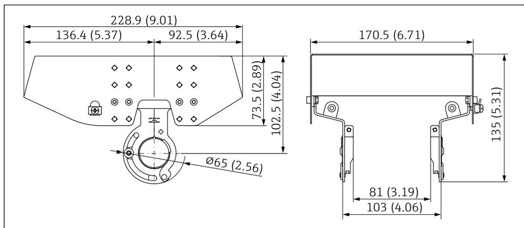
図 52 アルミニウム製デュアルコンパートメントハウジング用保護カバー。測定単位 mm (in)
