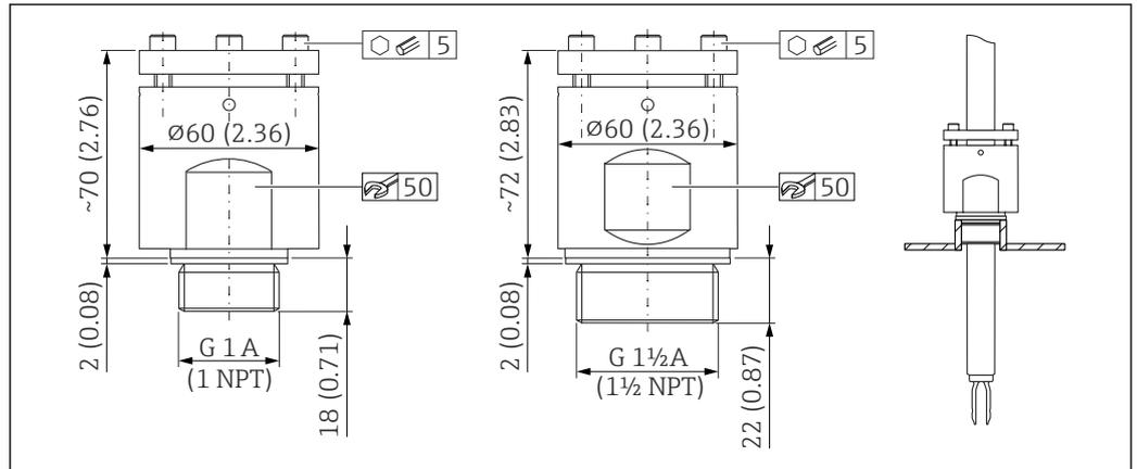
図 55 高圧用スライディングスリーブ。測定単位 mm (in)
