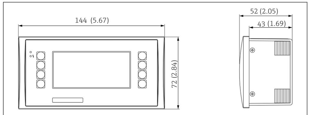
図 50 パネル取付用のディスプレイ/操作ユニット。測定単位 mm (in)
