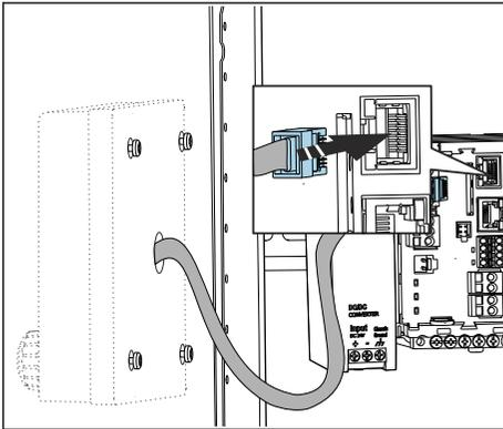
Raccorder le câble d'affichage au connecteur RJ-45 du module de base. Le connecteur RJ-45 porte l'inscription **Display**.
