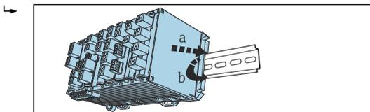
3. Faire glisser les pattes de fixation vers le haut jusqu'au clic et fixer l'appareil sur le rail DIN.
