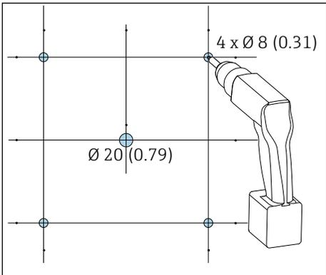
🔧 16 Diamètre des trous de perçage en mm (in)
