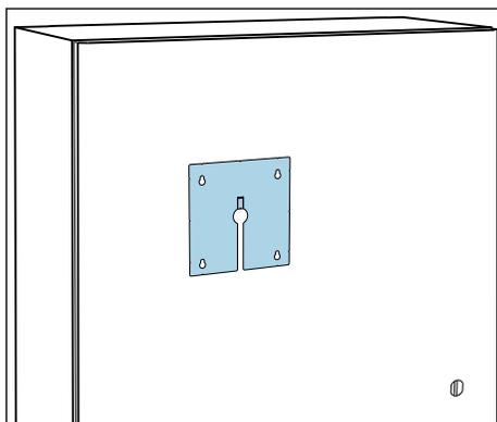
Maintenir la plaque de montage à l'extérieur contre la porte de l'armoire. Sélectionner la position à laquelle l'afficheur doit être monté.
