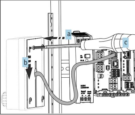
Positionner la plaque de montage à l'intérieur sur les vis (a), la faire glisser vers le bas (b) et serrer les vis (c).
