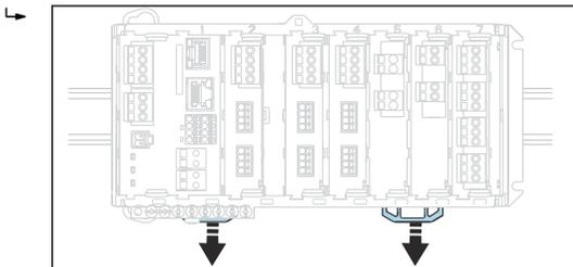
2. Accrocher l'appareil par le haut sur le rail DIN (a), puis presser fermement vers le bas (b).
