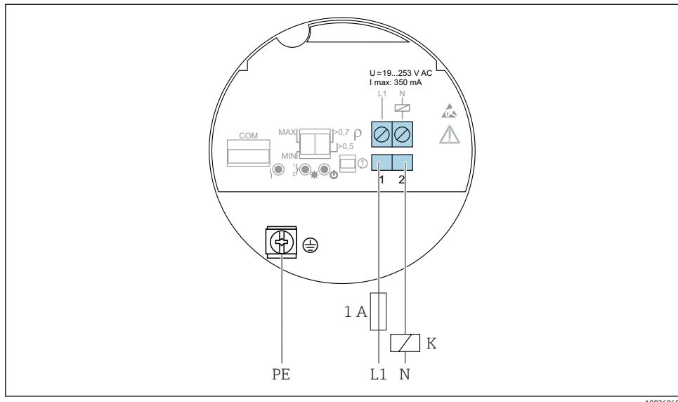
図 14 2 線式 AC、エレクトロニックインサート FEL61
