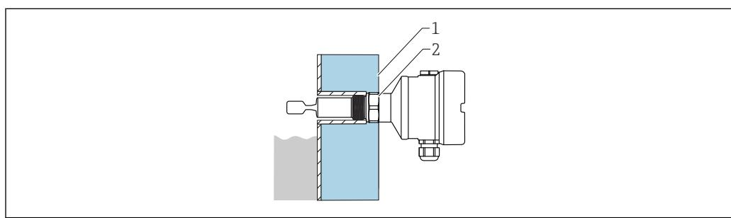
■ 16 Резервуар с теплоизоляцией (пример)
