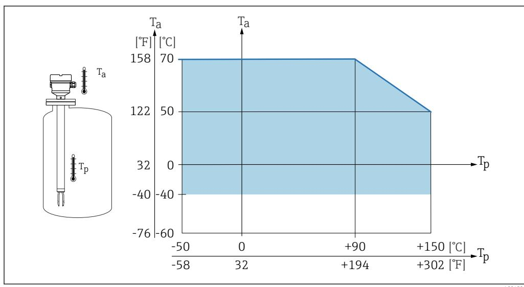
■ 19 Зависимость допустимой температуры окружающей среды  $T_a$  в зоне корпуса от рабочей температуры  $T_p$  в резервуаре
