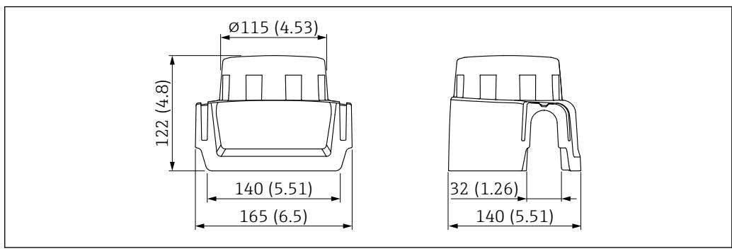
■ 42 Защитный козырек для однокамерного корпуса из алюминия. Единица измерения мм (дюйм)
