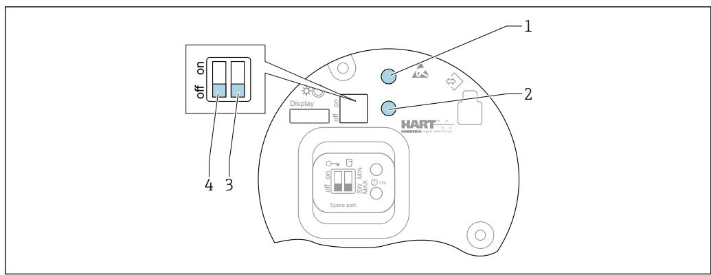
■ 39 Кнопки управления и DIP-переключатель на электронной вставке FEL60H
