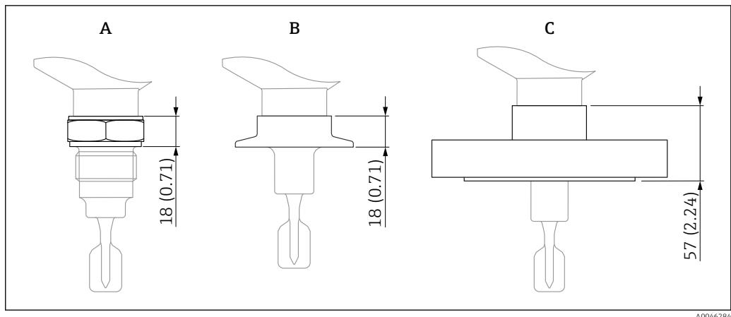
27 Спецификация максимальной высоты для технологических соединений. Единица измерения мм (дюйм)
