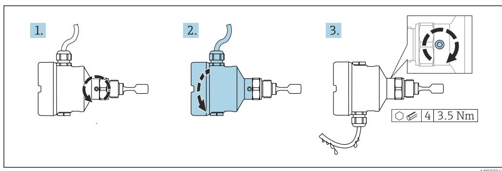
■ 15 Корпус с наружным стопорным винтом и ниспадающей кабельной петлей
