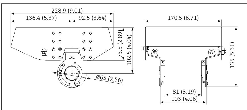
■ 41 Защитный козырек от погодных явлений для корпуса с двумя отсеками. Единица измерения мм (дюйм)
