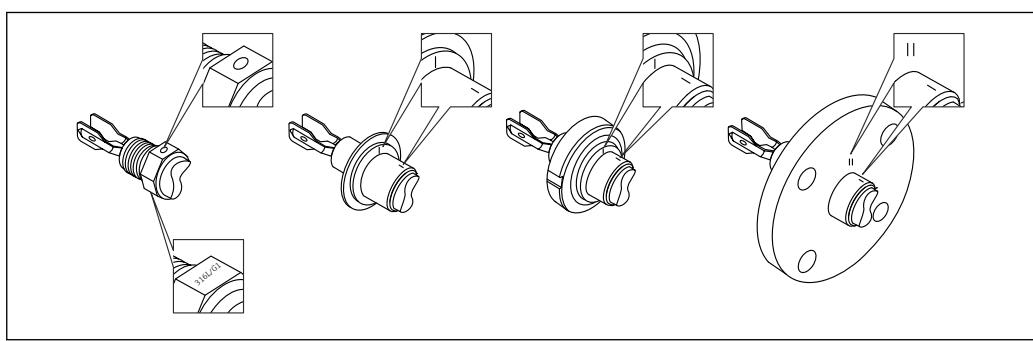
■ 13 Положение вибрационной вилки при горизонтальном монтаже в резервуаре с использованием маркировки
