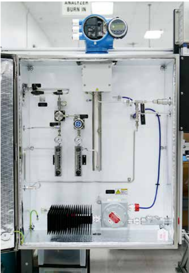
Vue intérieure d'un système combinant les analyseurs J22 et OXY5500
