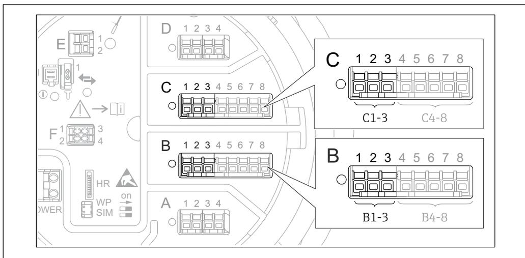
69 Возможное расположение аналоговых модулей ввода/вывода, которые могут использоваться в качестве выхода 4–20 мА. Код заказа для прибора зависит от того, какие из этих модулей фактически имеются в приборе → 49.
