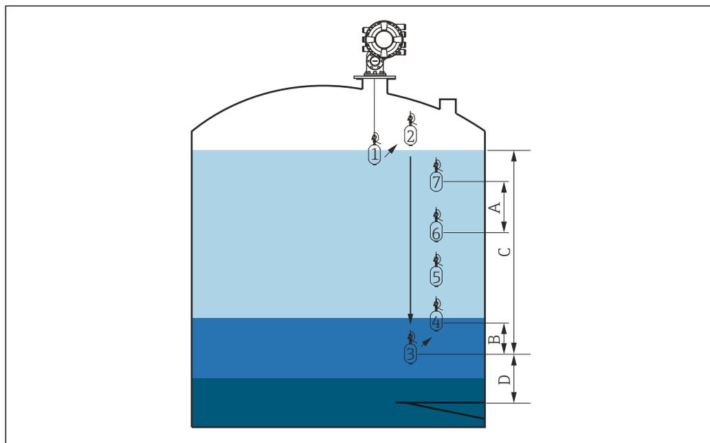
56 Движение при ручном измерении профиля (числа обозначают последовательность движения буйка)
