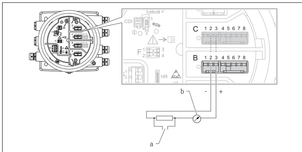
24 Использование модуля аналогового ввода/вывода в режиме активного выхода
