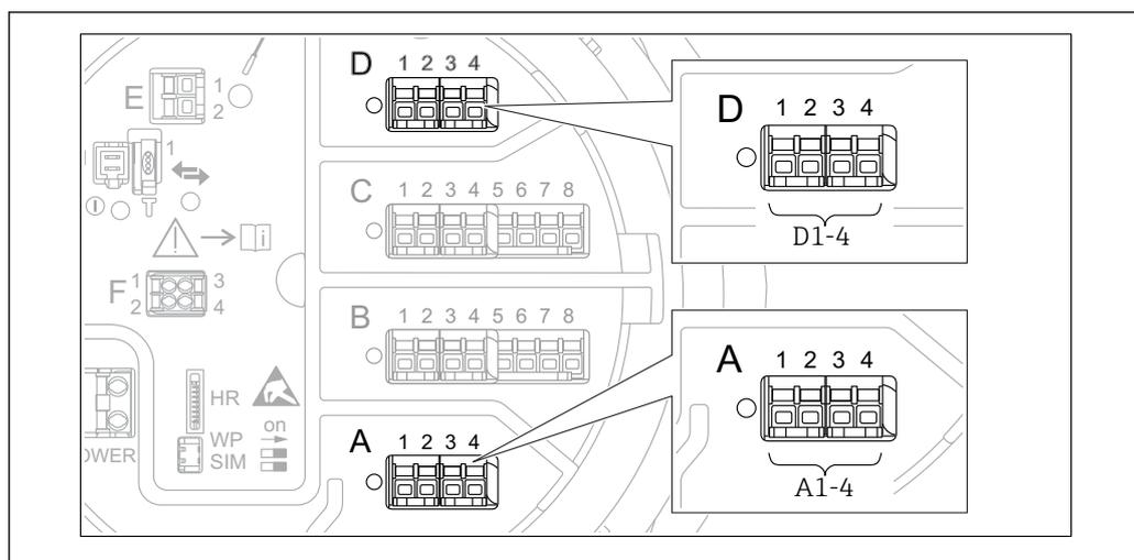
20 Обозначение модулей Modbus, V1 или WM550 (примеры). В зависимости от исполнения прибора данные модули могут находиться в гнезде В или С.
