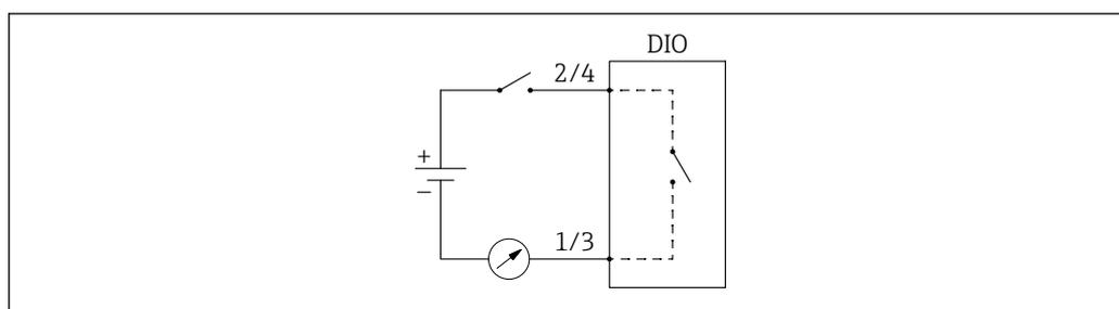
76 Использование цифрового модуля ввода/вывода в качестве цифрового выхода
