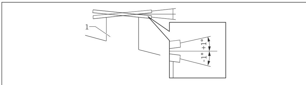
**11** Допустимый наклон монтажного фланца
