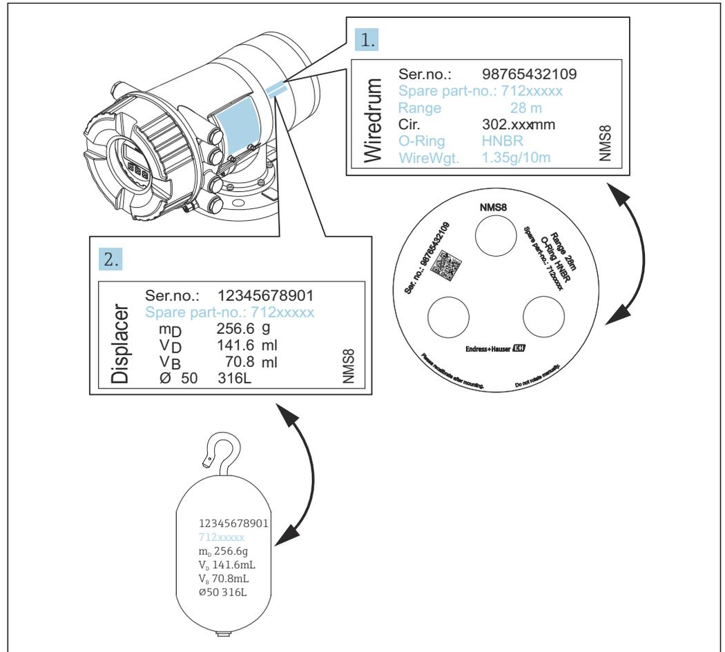
13 Проверка буйка и барабана с тросом
