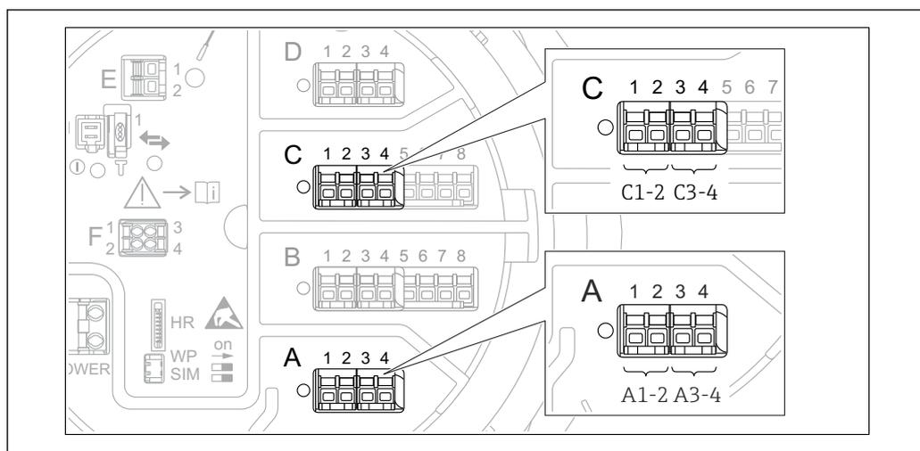
75 Возможное расположение цифровых модулей ввода/вывода (примеры); код заказа определяет номер и положение цифровых модулей ввода/вывода → 49.
