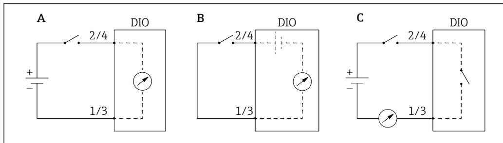
91 Режимы работы модуля цифрового ввода/вывода
