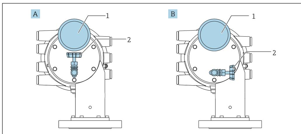
80 Монтажная позиция перепускного клапана и датчика давления
