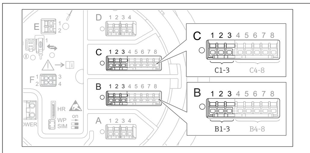
60 Возможное расположение аналоговых модулей ввода/вывода, которые могут использоваться в качестве входов 4–20 мА. Код заказа для прибора зависит от того, какие из данных модулей фактически имеются в приборе → 49.
