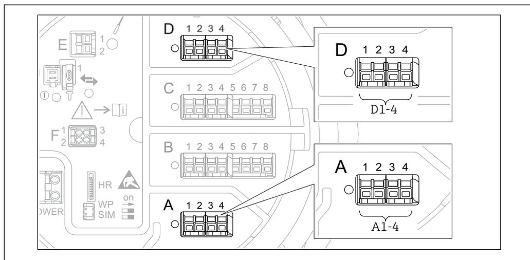
72 Возможное расположение модулей Modbus (примеры); в зависимости от исполнения прибора данные модули также могут находиться в гнезде B или C → 49.
