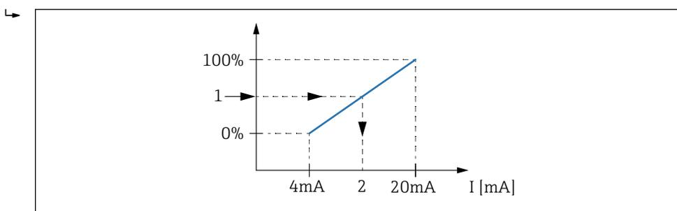
70 Масштабирование переменной резервуара в соответствии с выходным током
