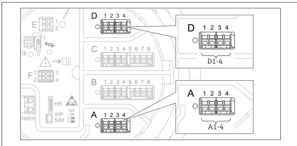
93 Обозначение модулей Modbus, V1 или WM550 (примеры). В зависимости от исполнения прибора эти модули могут находиться в гнезде В или С.
