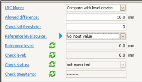
Zu Parameter **LRC Modus** wechseln und Option **Vergleiche mit Füllstandsgerät** wählen.
