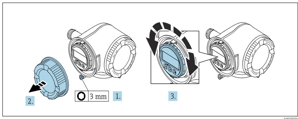
1. Je nach Geräteausführung: Sicherungskralle des Anschlussraumdeckels lösen.
