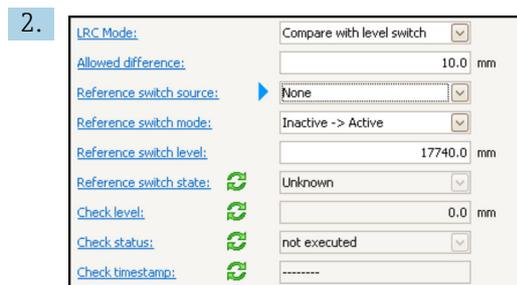
Zu Parameter **LRC Modus** wechseln und Option **Vergleiche mit Füllstandsschalter** wählen.
