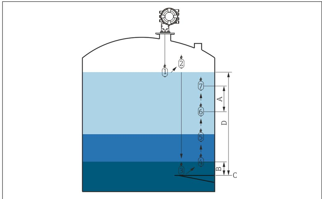
49 *Mouvement du profil de cuve (les numéros indiquent l'ordre des mouvements du déplacer.)*
