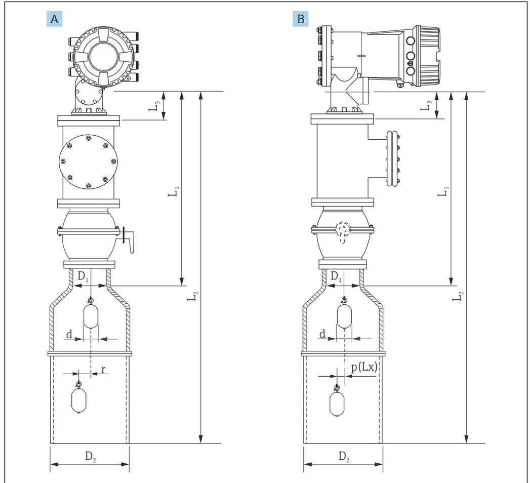
6 Montage avec un tube de mesure concentrique
