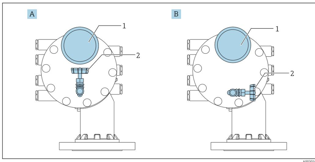
75 Position de montage de la soupape de décharge et du manomètre
