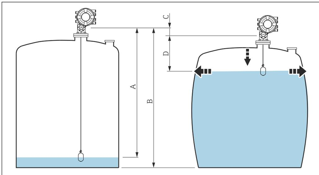
60 Correction de la déformation hydrostatique de la cuve (HyTD)
