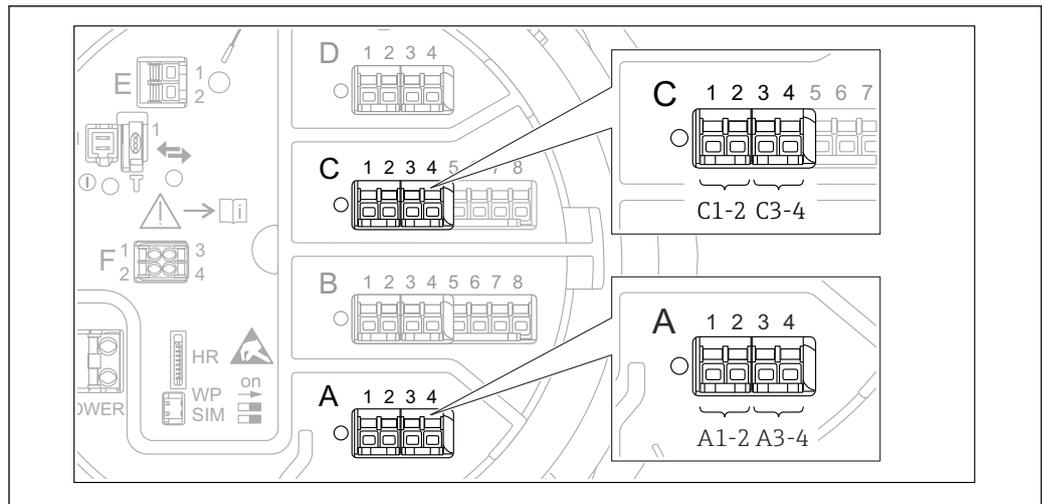
70 Emplacements possibles des modules Digital I/O (exemples) ; la référence de commande détermine le nombre et l'emplacement des modules Digital I/O → 40.
