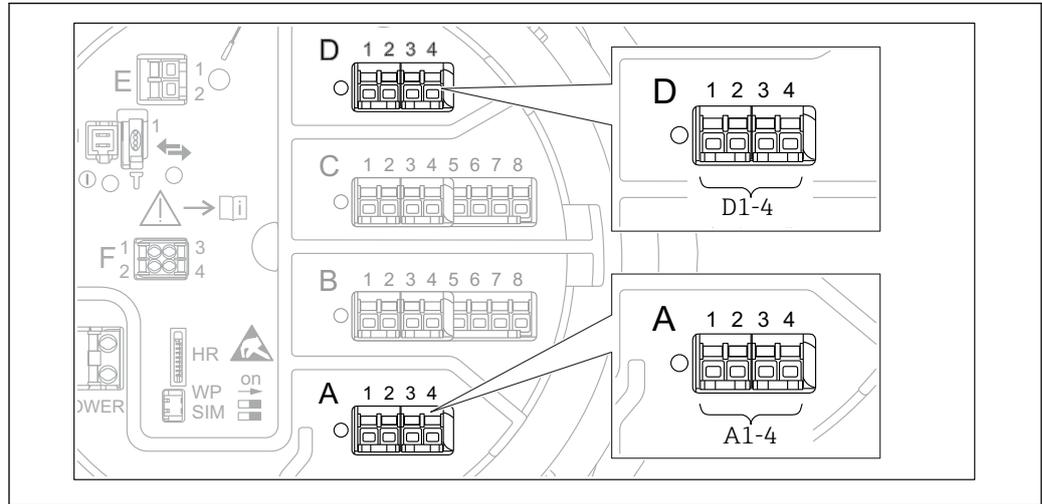
**67** Emplacements possibles des modules Modbus (exemples) ; selon la version d'appareil, ces modules peuvent également se trouver dans les slots B ou C → **40**.
