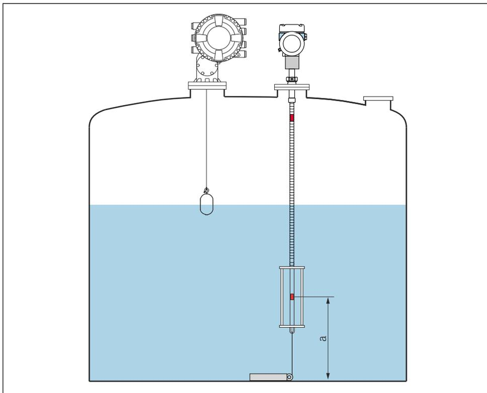
53 Prothermo NMT53x : position de l'élément de température du fond
