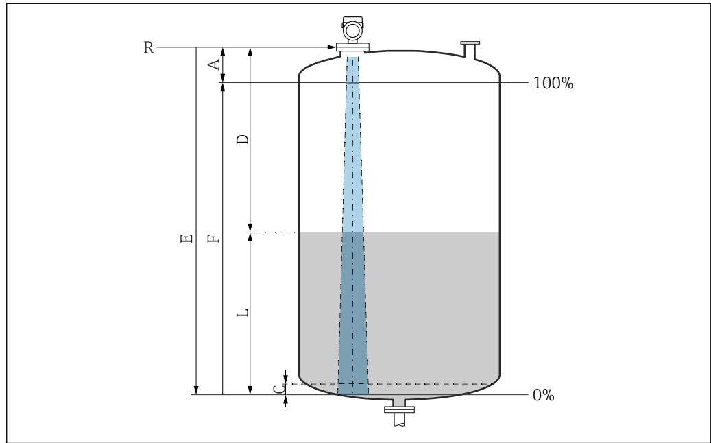
图 17 液位测量的设置参数
