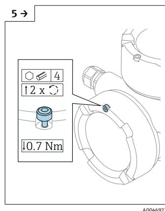
▶ 如果已安装接线腔盖：使用内六角扳手松开接线腔盖锁扣螺丝。
