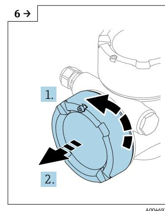
▶ 拧下接线腔盖，检查盖板密封圈。将接线腔盖（而非显示模块盖板）拧到电子腔上。如果已安装接线腔盖：使用内六角扳手拧紧接线腔盖锁扣螺丝。
