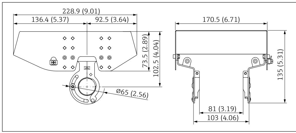
图 23 外形尺寸示意图。测量单位 mm (in)
