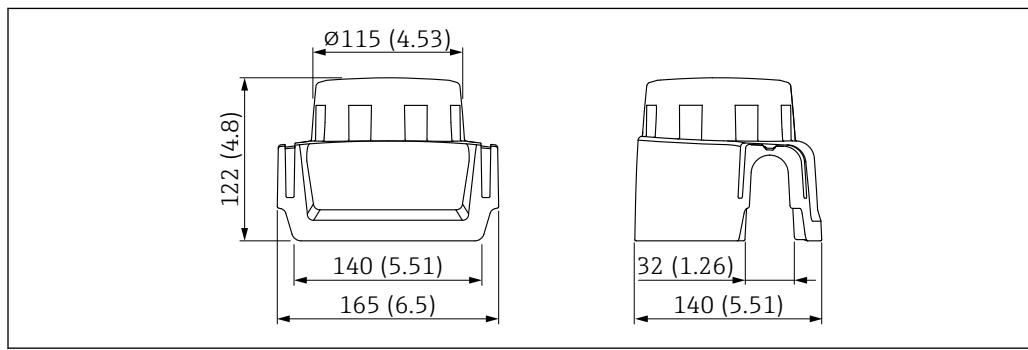
图 24 外形尺寸示意图。测量单位 mm (in)
