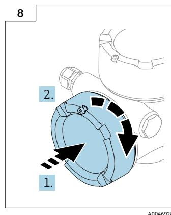
▶ 将显示模块盖板重新牢固拧至外壳上。如果已安装显示模块盖板：使用内六角扳手以0.7 Nm (0.52 lbf ft)扭矩拧紧显示模块盖板锁扣螺丝。
