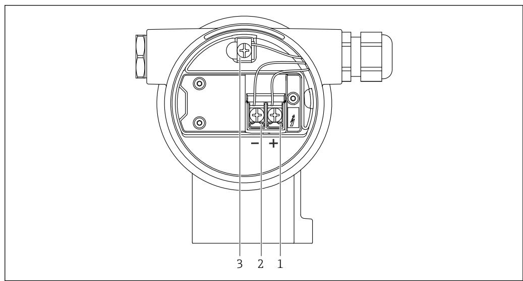
图 5 接线腔中的接线端子和接地端
