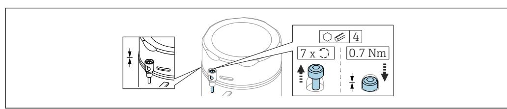
图 3 带锁定螺丝的外壳盖；卫生型外壳（仅适用粉尘防爆场合）
