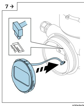
▶ 将显示模块连接线插头插入接线腔。
