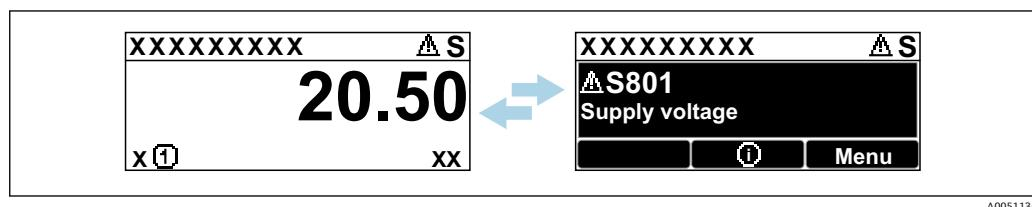
图 18 诊断信息与测量值交替显示
