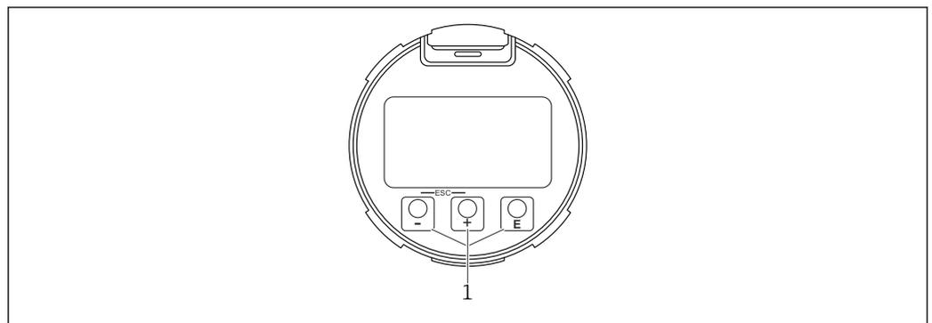
图 57 图形显示单元，带光敏按键 (1)
