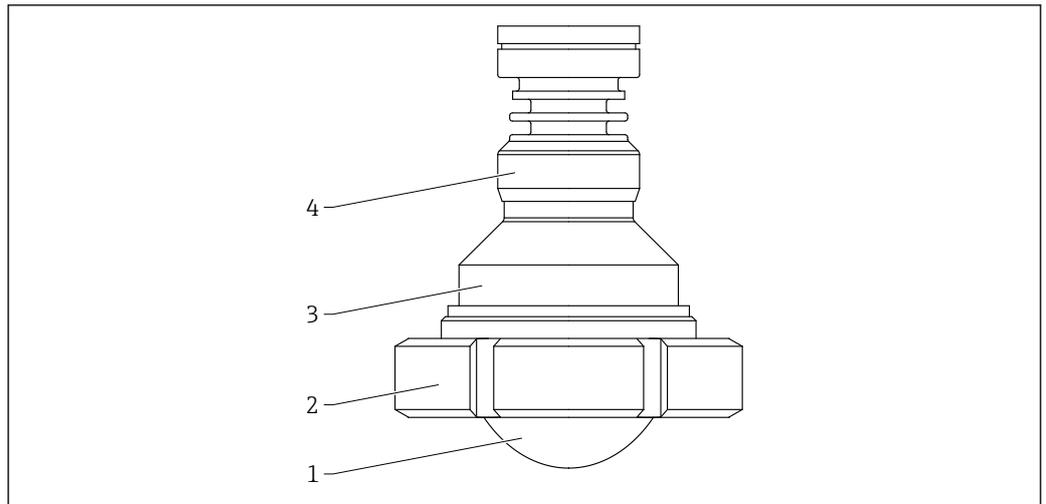
☑ 53 涂层天线（齐平安装，80 mm (3 in)口径）的材质；带 DIN11851 开槽螺母。测量单位 mm (in)
