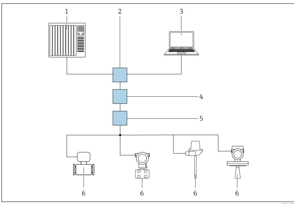
图 59 通过 PROFINET + Ethernet-APL 网络实现远程操作：星形拓扑结构
