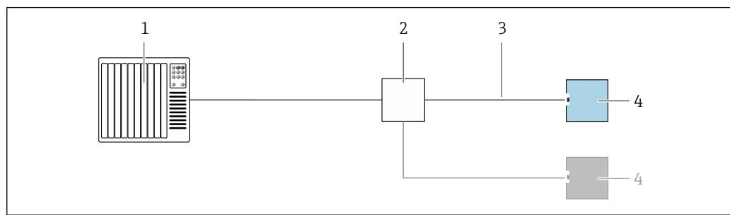
图 8 接线示例：具有 Ethernet-APL 功能的 PROFINET
