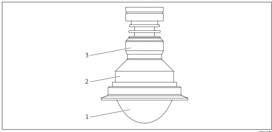
图 56 PTFE 涂层天线 (齐平安装, 80 mm (3 in)口径) 的材质; 带 ISO2852 Tri-Clamp 卡箍
