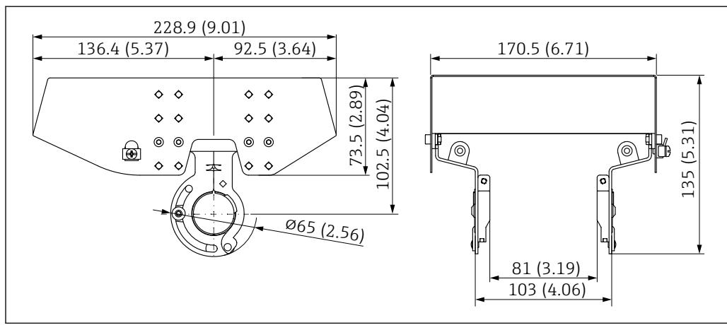
图 60 外形尺寸示意图。测量单位 mm (in)
