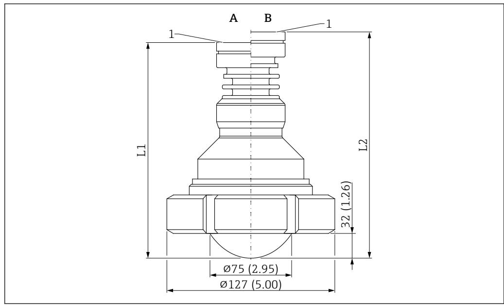
图 48 PTFE 涂层天线 (齐平安装, 80 mm (3 in)口径) 的外形尺寸示意图; 带 DIN11851 开槽螺母。测量单位 mm (in)
