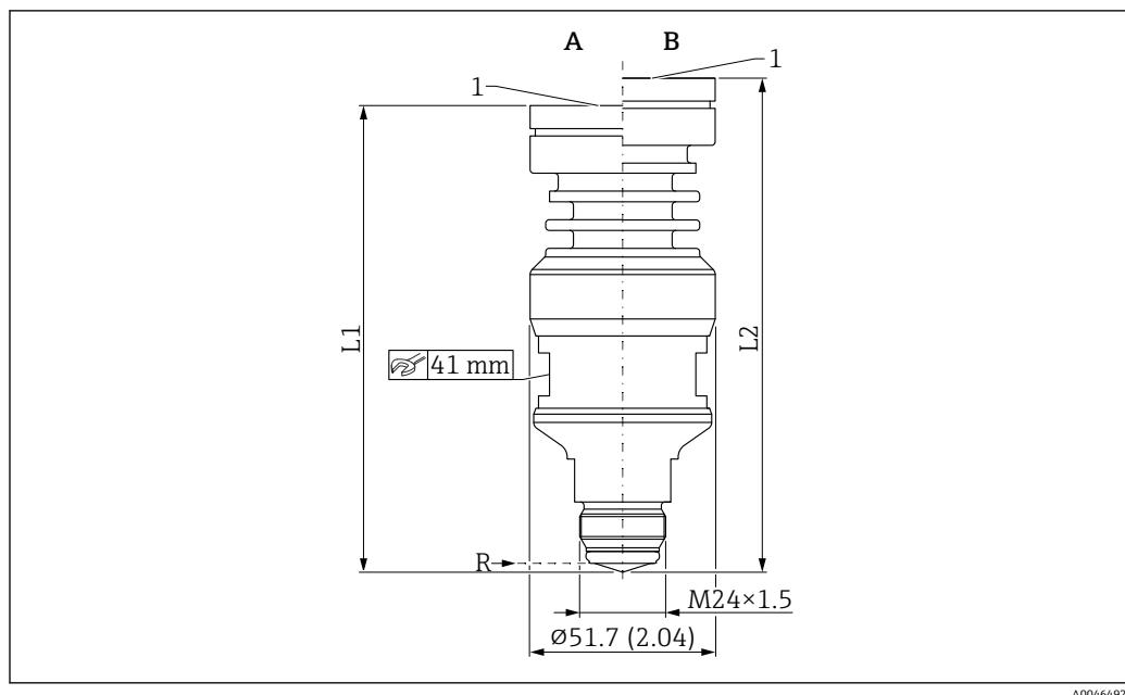
图 46 PEEK 一体式天线 (20 mm 口径) 的外形尺寸示意图; M24×1.5 过程连接。测量单位 mm (in)
