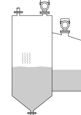
**PTFE 涂层天线, 齐平安装, 50 mm (2 in)口径, 在储罐中测量**
