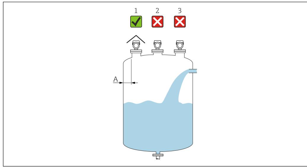
**A** 罐壁与安装短管外壁间的推荐安装距离：约为罐体直径的 1/6。仪表安装位置与罐壁间的距离不得小于 15 cm (5.91 in)。
