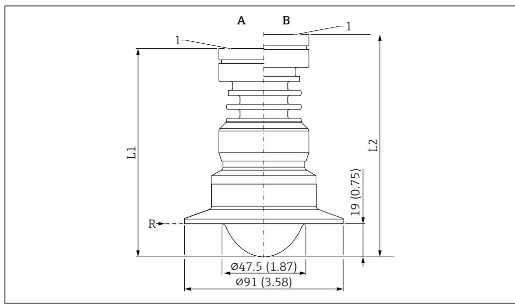
图 50 PTFE 涂层天线 (齐平安装, 50 mm (2 in)口径) 的外形尺寸示意图; 带 ISO2852 Tri-Clamp DN70-76.1 (3") 卡箍。测量单位 mm (in)
