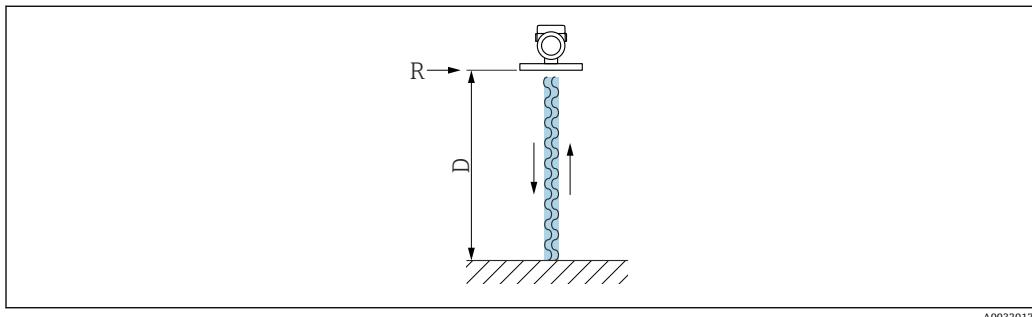
图 1 FMCW 原理：发送和反射连续波
