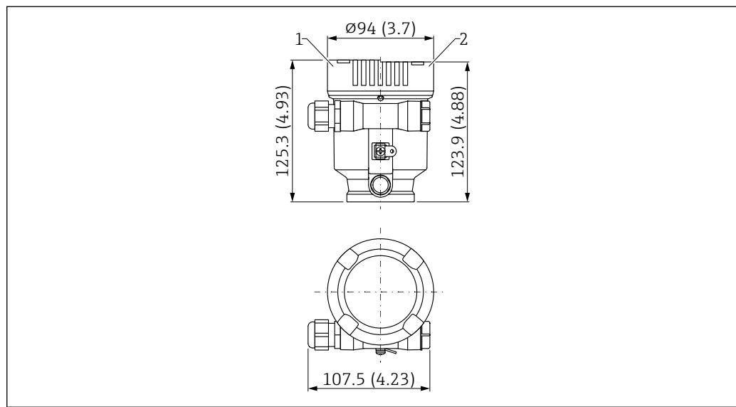
图 41 单腔体塑料 (PBT) 外壳的外形尺寸示意图。测量单位 mm (in)
