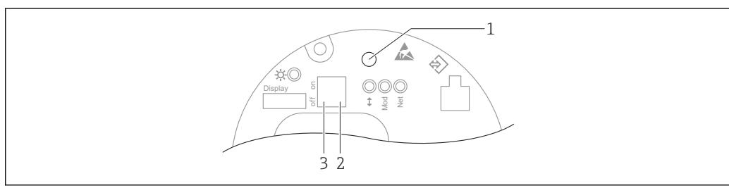
图 57 Ethernet-APL 电子插件上的操作按键和 DIP 开关
