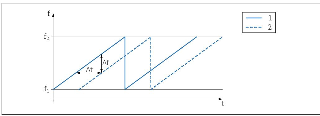
图 2 FMCW 原理：调频结果
