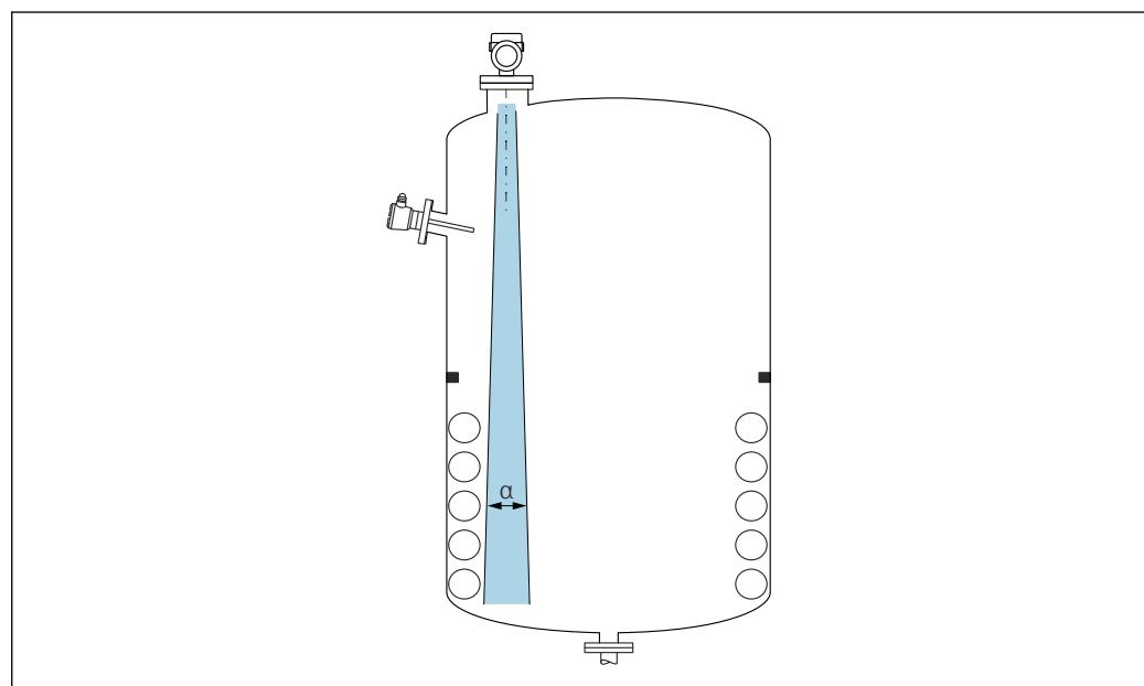
在信号波束范围内避免安装任何内部装置（例如限位开关、温度传感器、立杆、真空环、加热盘管、挡板等）。注意波束角 **a**。
