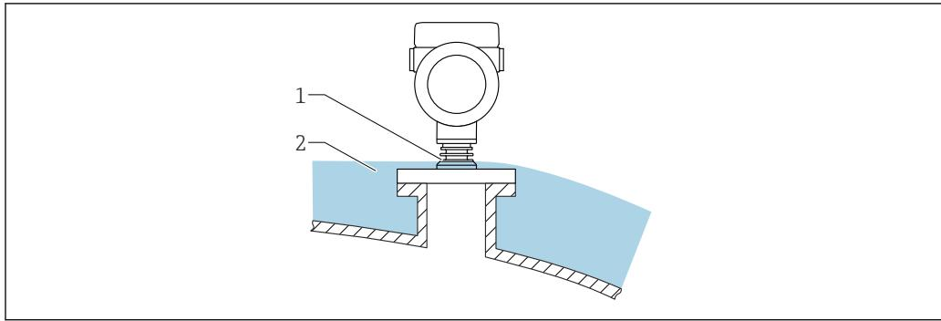
如果过程温度很高，必须同时将仪表主体置于罐体保温层（2）中，避免热辐射或热对流导致仪表内部电子部件过热。凸条结构（1）处不得被保温层包裹。
