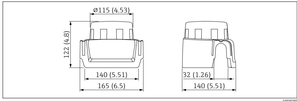
图 61 外形尺寸示意图。测量单位 mm (in)
