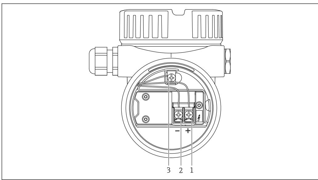
图 6 接线腔中的接线端子和接地端
