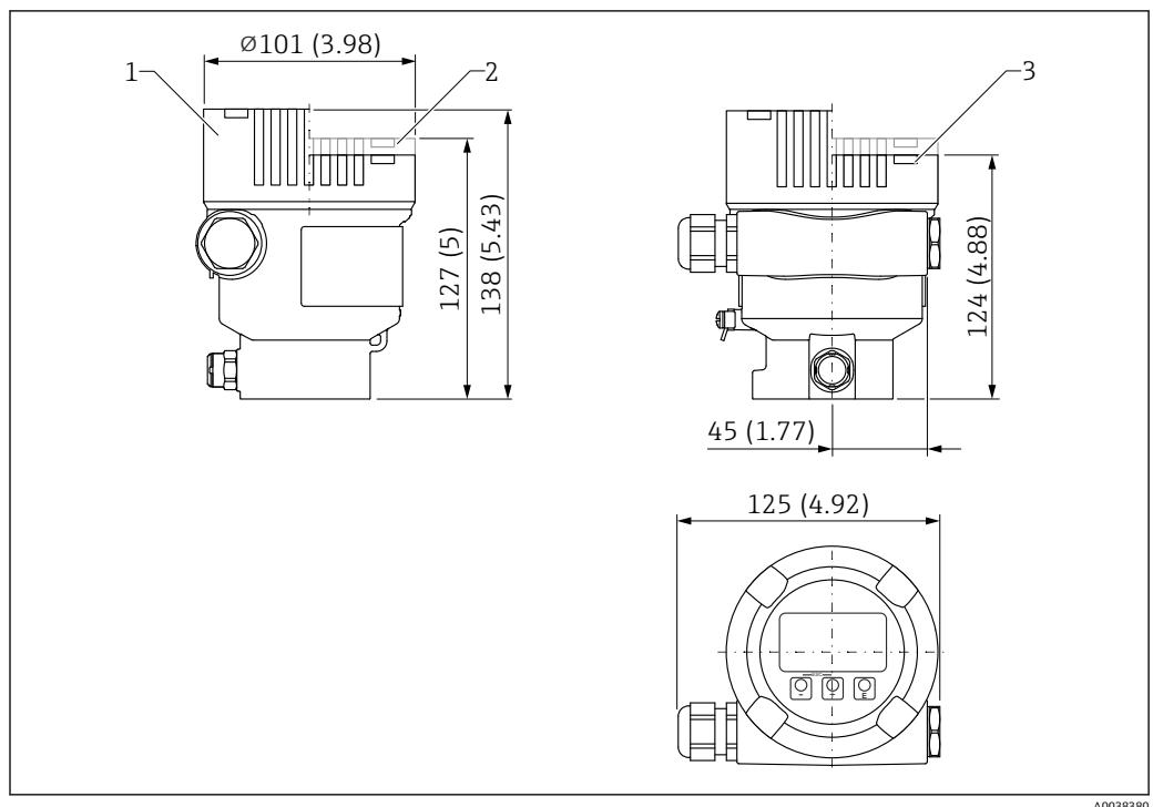
图 42 单腔体铝外壳的外形尺寸示意图。测量单位 mm (in)
