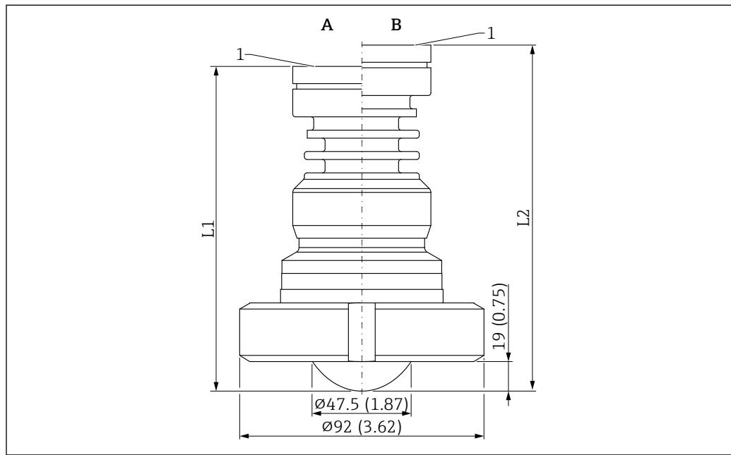
图 47 PTFE 涂层天线 (齐平安装, 50 mm (2 in)口径) 的外形尺寸示意图; 带 DIN11851 开槽螺母。测量单位 mm (in)
