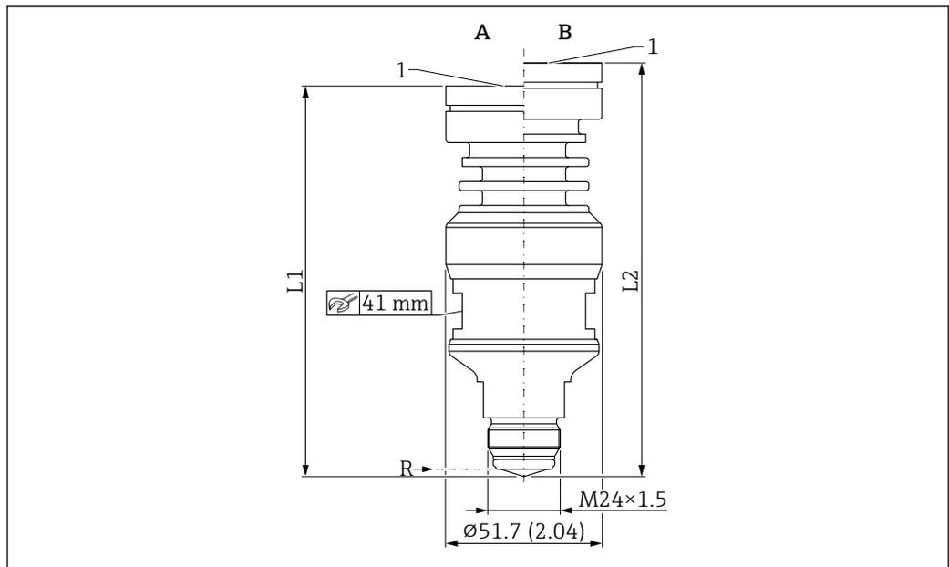
46 Dimensões da antena integrada, PEEK, 20 mm / M24×1.5. Unidade de medida mm (in)
