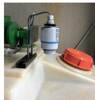
Transmisor radar para la medida de nivel, configuración mediante Bluetooth® (iOS, Android) para puesta en marcha, operación y mantenimiento: ahorra tiempo y reduce costes
