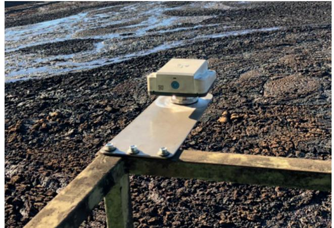
Transmisor radar para la medida de nivel, equipo autónomo con batería y tarjeta SIM para su instalación en depósitos o balsas remotas (sin posibilidad de alimentación eléctrica ni cableado de señal)
