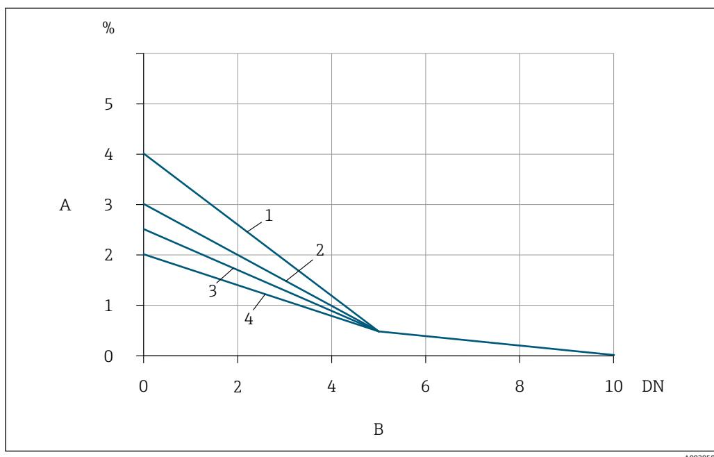
图 21 已安装流量调节器时可能存在的附加测量误差，与干扰因素和前管段类型相关
