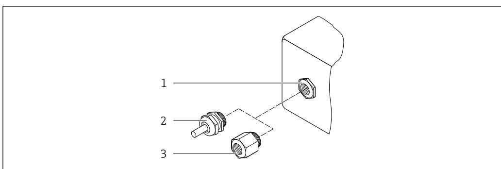
图 35 允许的电缆入口/缆塞
