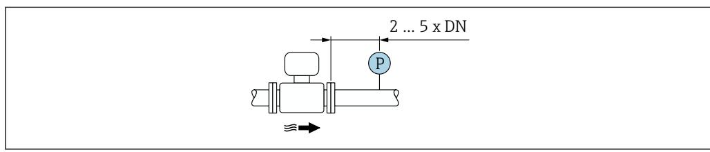
图 22 压力测量点的安装示意图 (P = 压力变送器)
