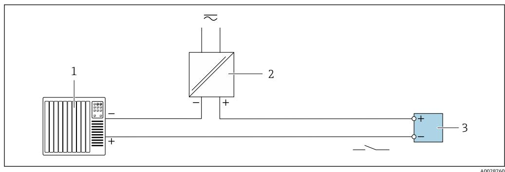
图 9 接线实例：开关量输出（无源信号）
