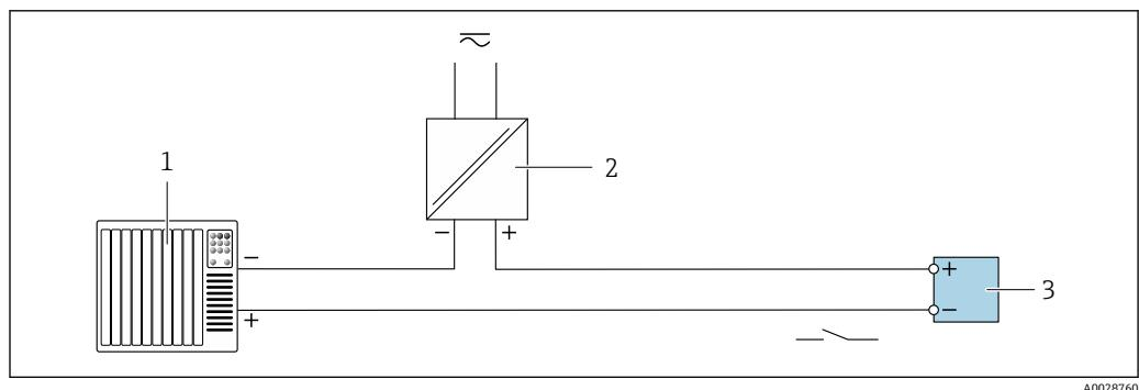
图 10 接线实例：继电器输出（无源信号）
