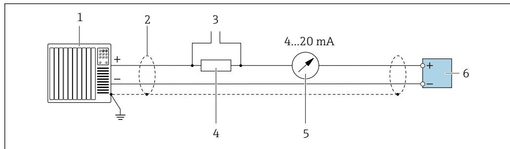
图 2 4...20 mA HART 电流输出（有源）的接线图
