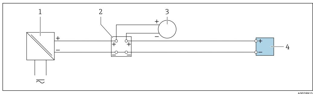
图 11 接线实例：4...20 mA 电流输入
