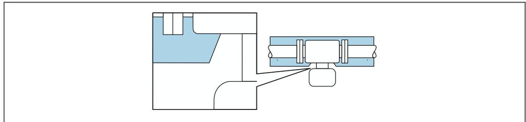
14 Isolation thermique avec tube prolongateur non isolé
