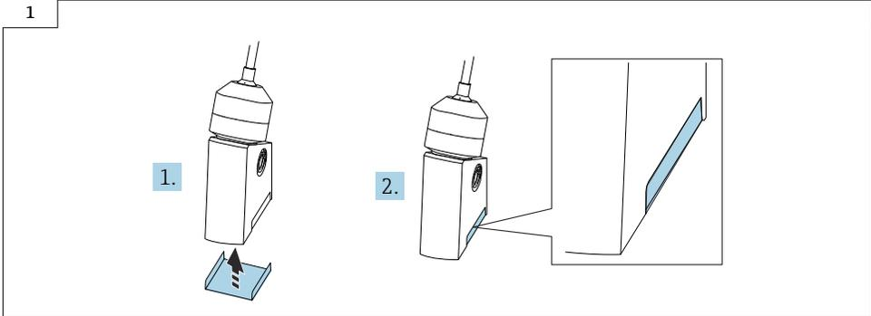
▶ Folien an die leicht angeschrägte Fläche der Sensorkörper einfalten.
