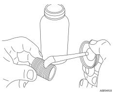
Figure 3. Applying conduit lubricant
