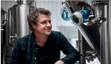
„Der Fermentation Monitor QWX43 hat bei uns nicht nur Überwachungsfunktion. Er ist ins Prozessleitsystem integriert und auf Basis seiner übermittelten Werte werden einzelne Schritte wie zum Beispiel die Ventilsteuerung oder das Aktivieren der Kühlung automatisch angepasst. So erreichen wir eine hohe Automatisierung des Gärprozesses, die sich für uns rechnet.“
