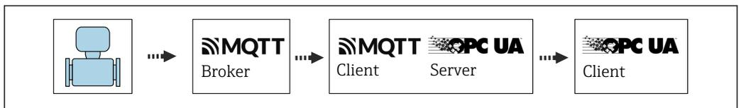
2 Mobilfunkverbindung über MQTT Broker, OPC-UA Server und TLS Verschlüsselung.
