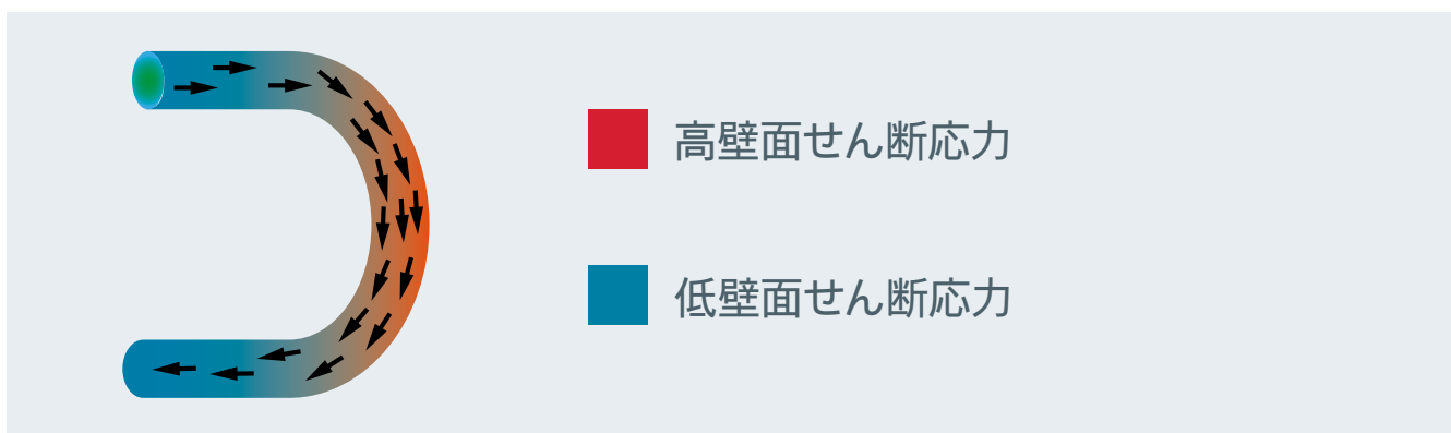
パイプバンドにおける壁せん断応力のシミュレーション
