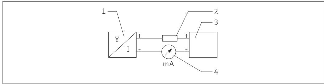
3 Diagrama de bloques de la conexión HART
