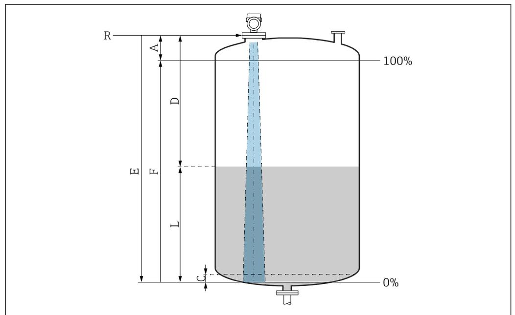
6 Parámetros de configuración para la medición de nivel en líquidos
