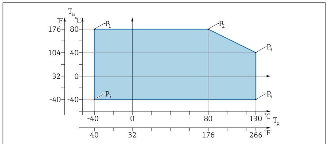
**9** Temperatura ambiente T<sub>a</sub> según la temperatura de proceso T<sub>p</sub>
