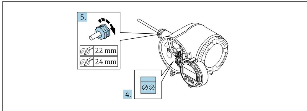
4. Conecte o cabo de acordo com o esquema de ligação elétrica .
