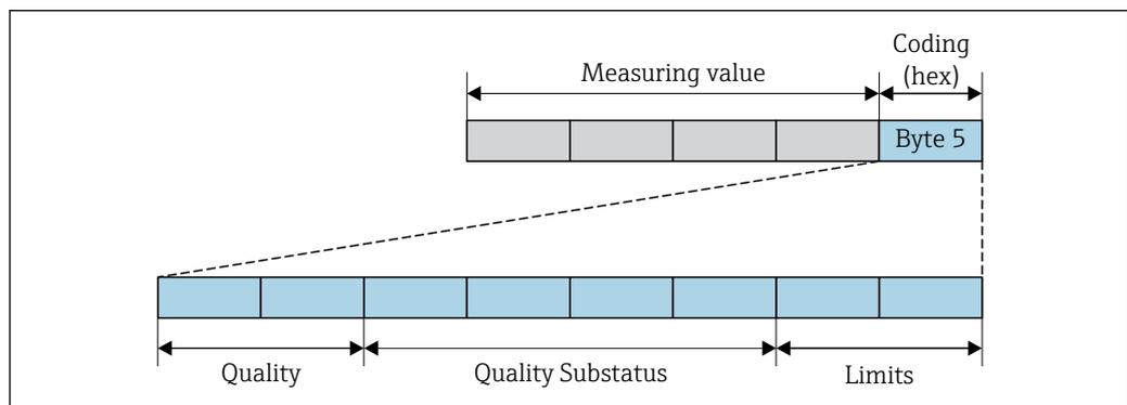
30 Struttura del byte di stato
