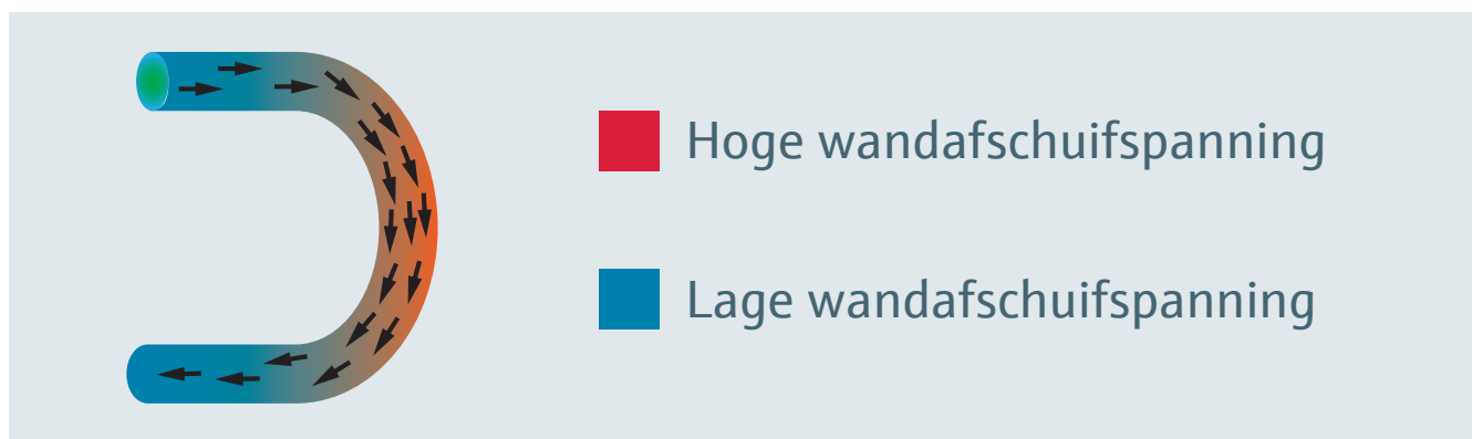
Simulatie van wandafschuifspanning in een leidingbocht
