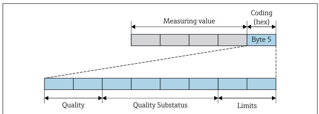
39 Struttura del byte di stato
