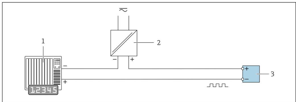
22 Exemple de raccordement pour sortie impulsion/fréquence (passive)
