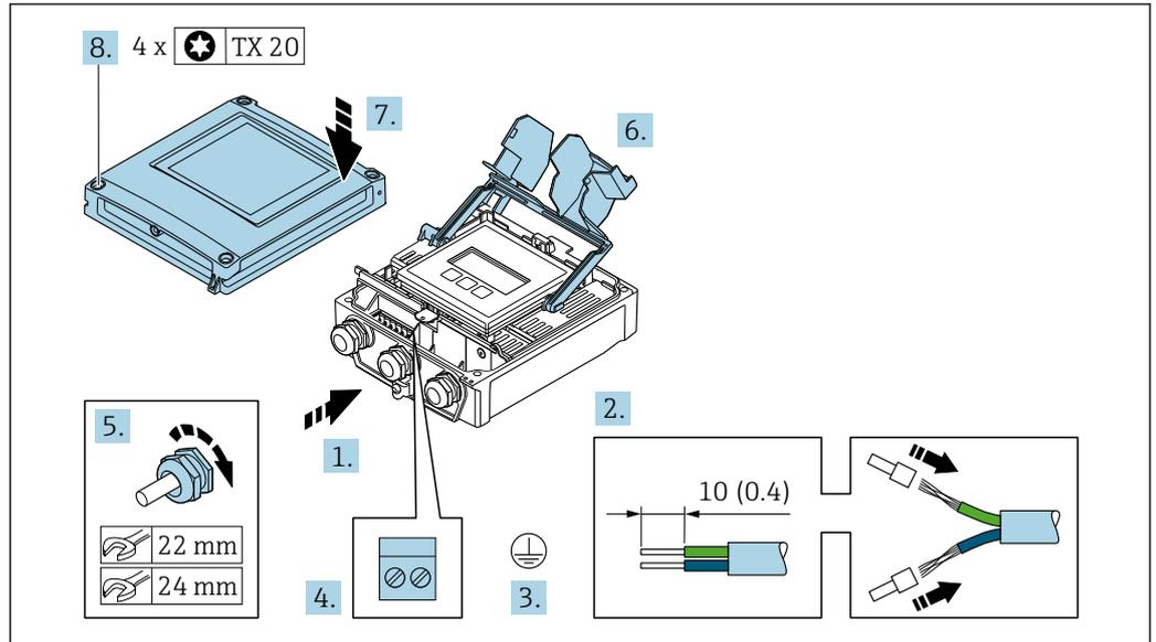
1. Passer le câble à travers l'entrée de câble. Pour garantir l'étanchéité, ne pas retirer la bague d'étanchéité de l'entrée de câble.
