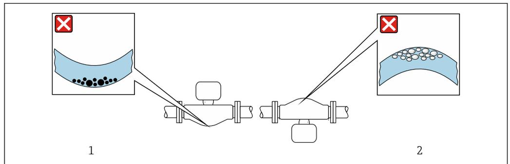
☑ 7 Position du capteur avec tube de mesure coudé
