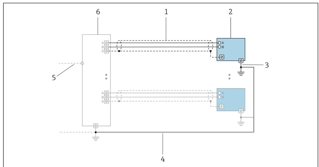
19 Exemple de raccordement pour PROFINET avec Ethernet-APL
