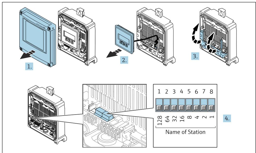
1. Desserrer les 4 vis de fixation sur le couvercle du boîtier.
