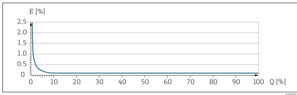
E Écart de mesure max. en % de m. (exemple)
