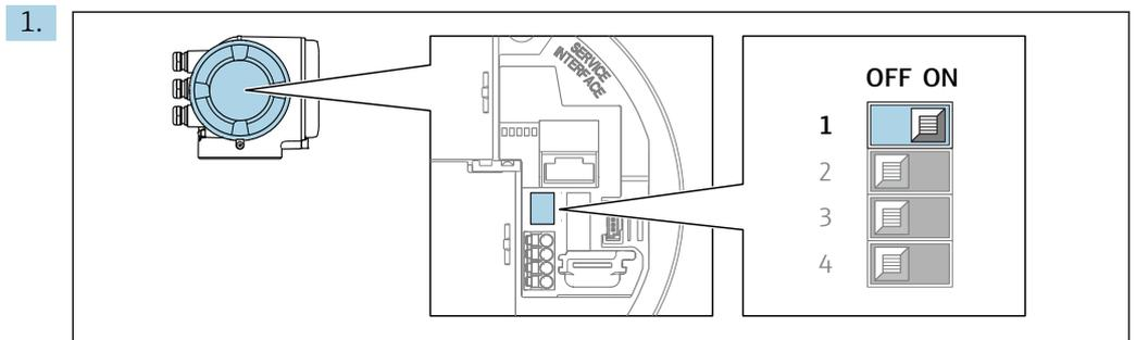
Mettre le commutateur de protection en écriture (WP) sur le module électronique principal sur **ON** permet d'activer la protection en écriture du hardware.
