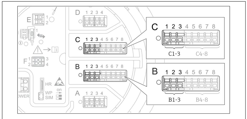
31 Mögliche Positionen der Analog I/O-Module, die als 4-20mA-Eingang verwendet werden können. Der Bestellcode des Geräts legt fest, welches dieser Module tatsächlich vorhanden ist → 25.
