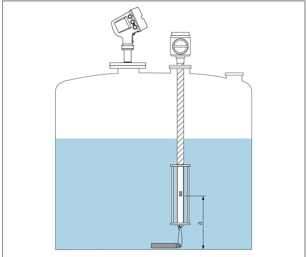
29 Prothermo NMT53x: Position des unteren Temperaturelements
