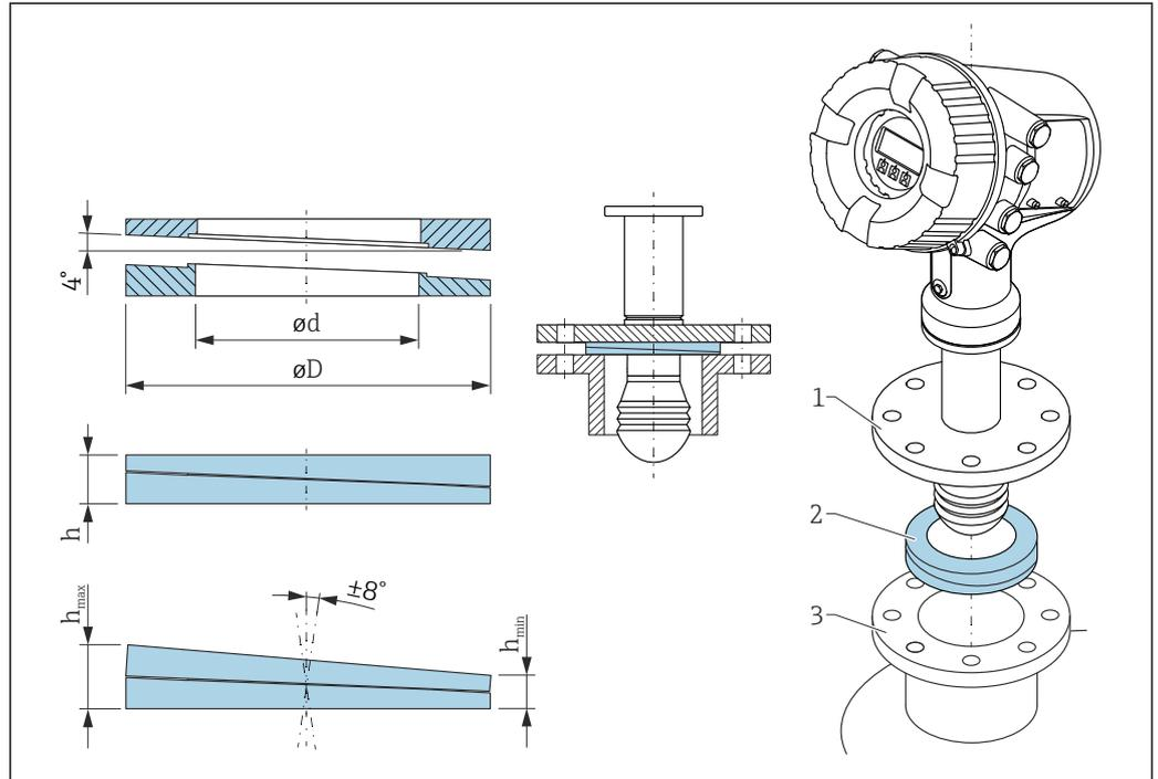
4 Anpassbare Dichtung, um das Gerät um  $\pm 8^\circ$  auszurichten
