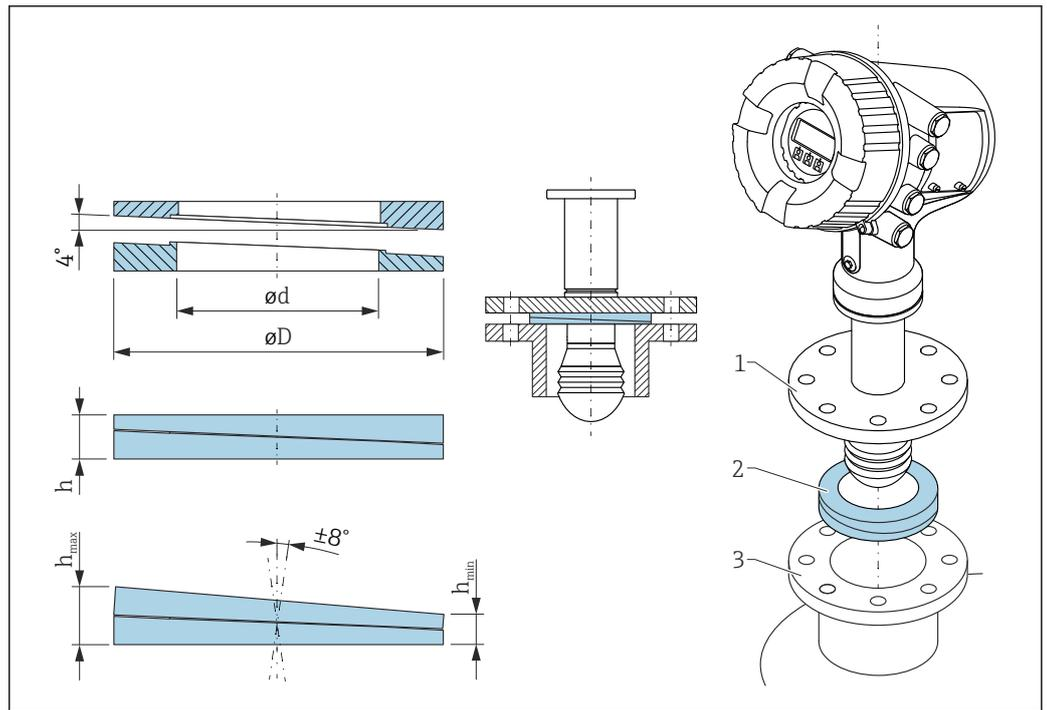
51 Anpassbare Dichtung, um das Gerät um  $\pm 8^\circ$  auszurichten
