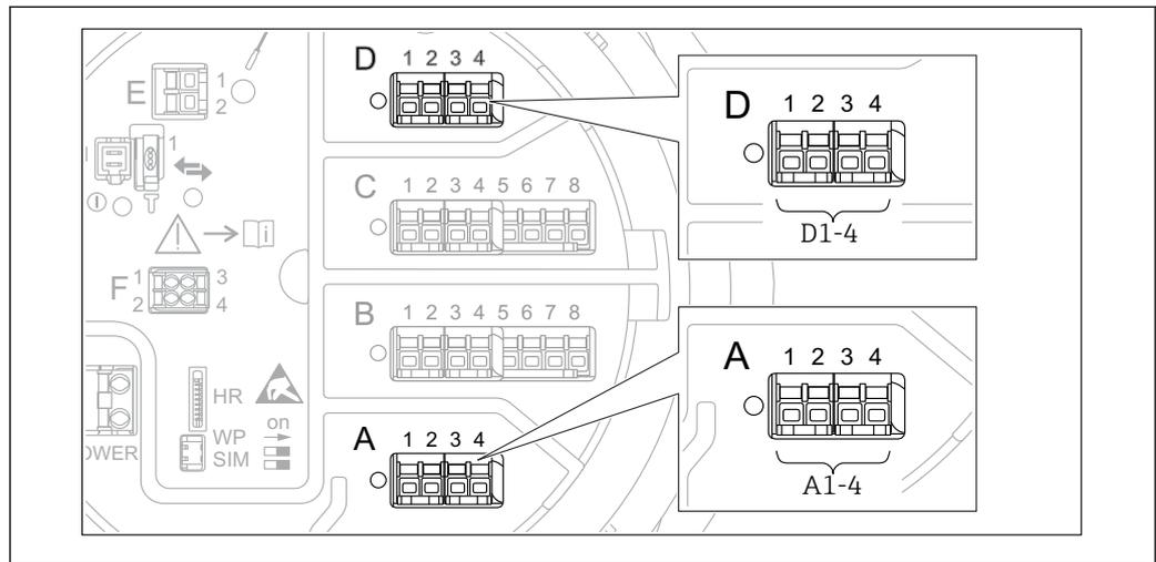
57 Bezeichnung der "Modbus"-, "V1"- oder "WM550"-Module (Beispiele); diese Module können je nach Geräteausführung auch in den Slots B oder C sitzen.
