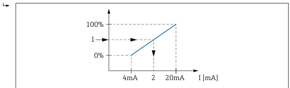
42 Tankvariable auf den Ausgangsstrom skalieren
