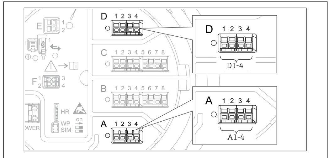
44 Mögliche Positionen der Modbus-Module (Beispiele); diese Module können je nach Geräteausführung auch in den Slots B oder C sitzen → 25.
