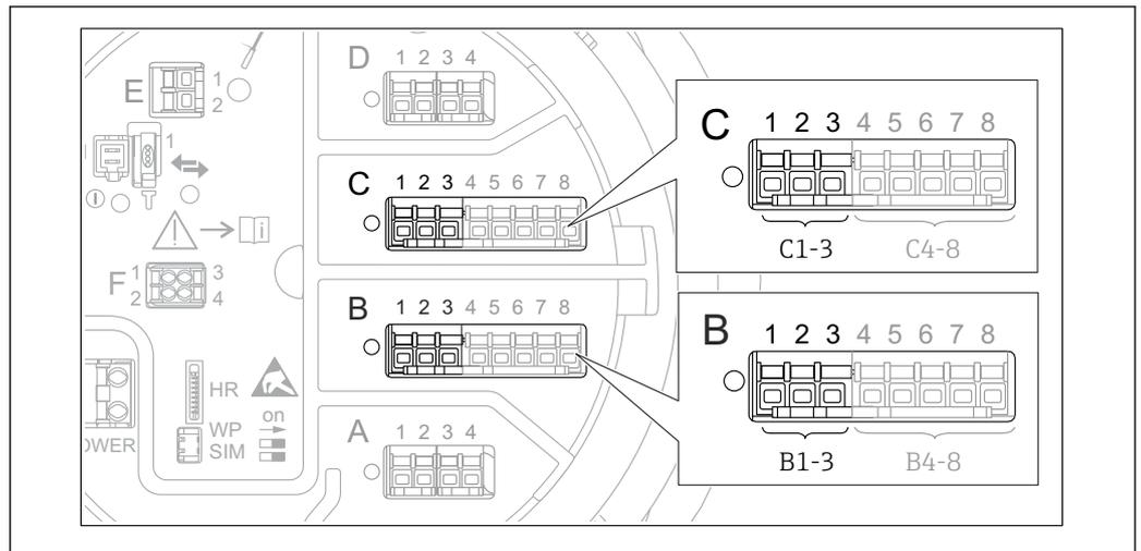
41 Mögliche Positionen der Analog I/O-Module, die als 4-20mA-Ausgang verwendet werden können. Der Bestellcode des Geräts legt fest, welches dieser Module tatsächlich vorhanden ist → 25.
