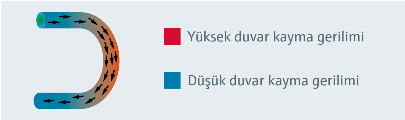
Boru dirseğinde duvar kayma geriliminin simülasyonu
