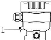
1 Клемма заземления для подключения линии выравнивания потенциалов
