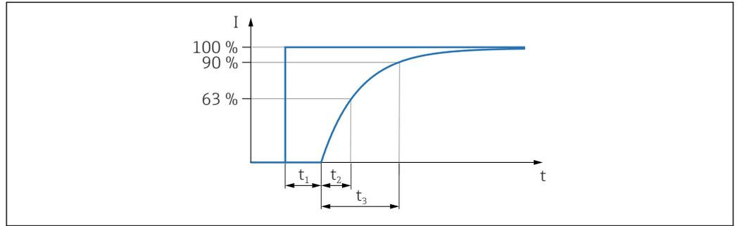
Tiempo de respuesta a un escalón = tiempo muerto ( $t_1$ ) + constante de tiempo T90 ( $t_3$ ) según IEC62828-1
