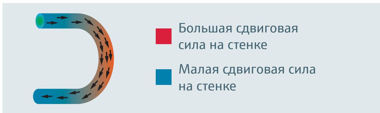
Модель действия сдвиговой силы на стенки в изгибе трубы
