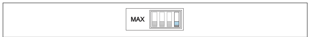
図 50 プローブが接粉状態になると、出力は安全側に切り替わります。これは溢れ防止などに活用できます。
