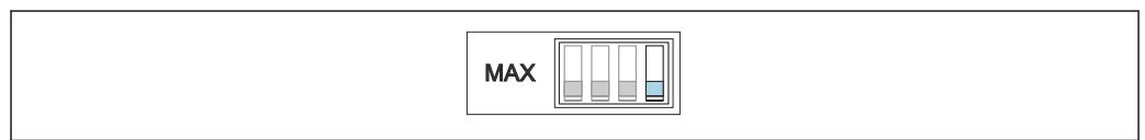
図 60 プローブが接粉状態になると、出力は安全側に切り替わります。これは溢れ防止などに活用できます。
