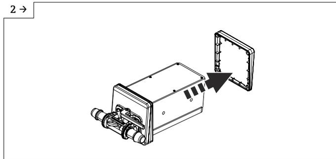
► Innenseitiger Keil entfernen. Je nach Einbaulage, aussenseitigen Keil drehen. Einbaulage →
