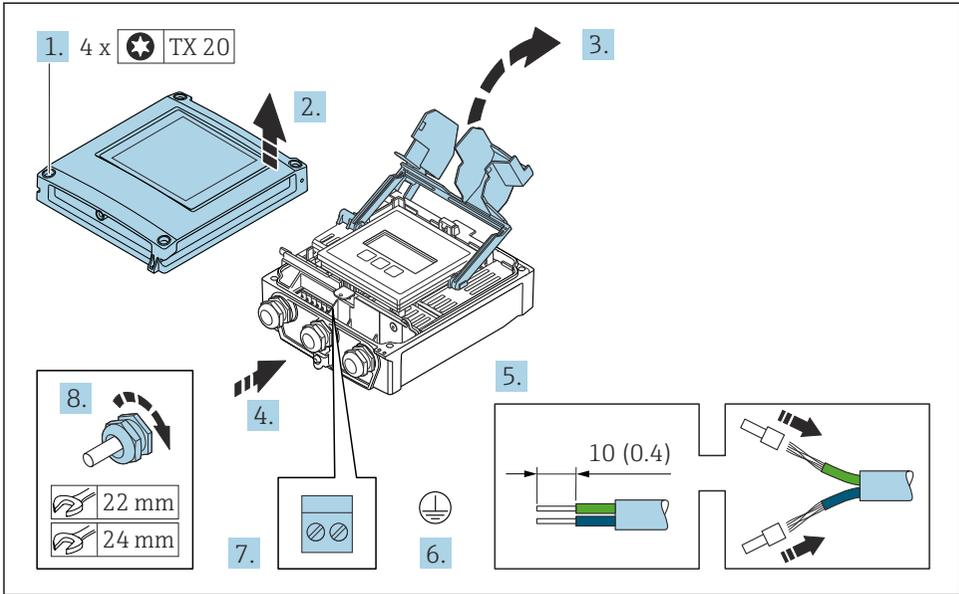
1. Solte os 4 parafusos de fixação da tampa do invólucro.
