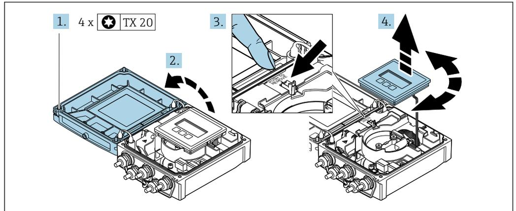
1. Befestigungsschrauben des Gehäusedeckels lösen.
