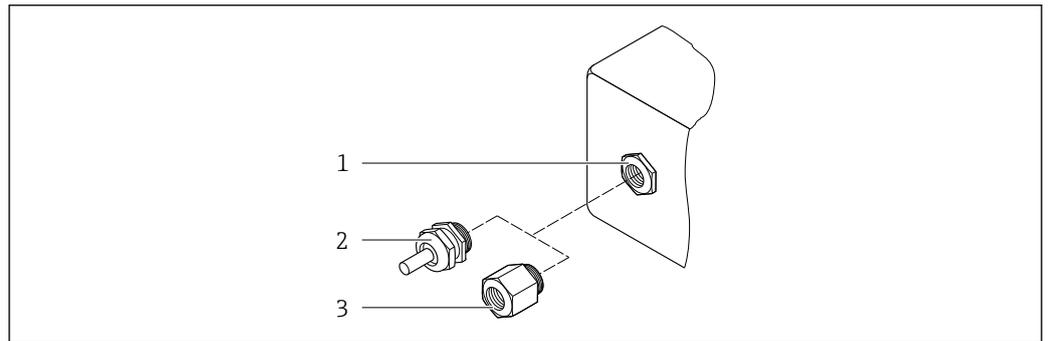
27 Mögliche Kabeleinführungen/-verschraubungen
