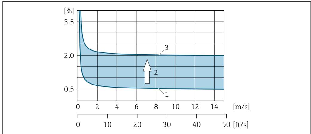
25 Beispiel für die Messabweichung in einer Rohrleitung mit Nennweite DN > 200 (8")
