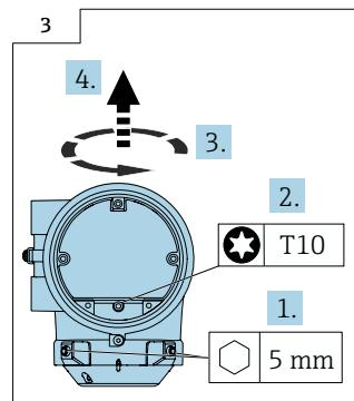
► Inbusschrauben rechts und links am Messumformergehäuse lösen, Verdrehssicherung lösen. Messumformergehäuse drehen und abziehen .
