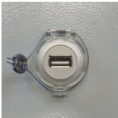
図 29 シールワイヤで封止された USB ポート
