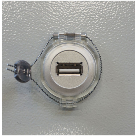
图 29 使用封锁线锁死 USB 端口
