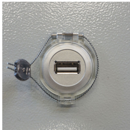
29 Port USB zabezpieczony drutem plombującym
