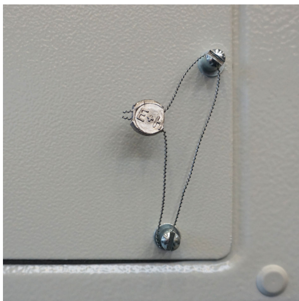
27 Śruby zaplombowane drutem plombującym
