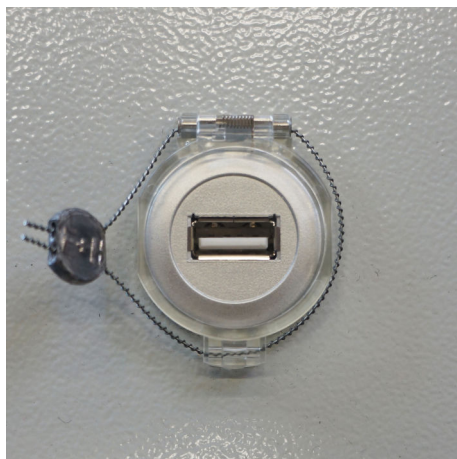
29 USB-порт, опломбированный пломбировочной проволокой
